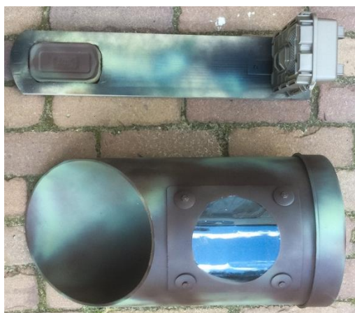
afbeelding 4. Voor beeld van de 'Struikrover'. De val bestaat uit een pvc-buis met venster (linksonder) waar een plankje met het lokmiddel en de camera (linksboven) in wordt vastgemaakt. Het geheel wordt in het veld geplaatst (rechts).
