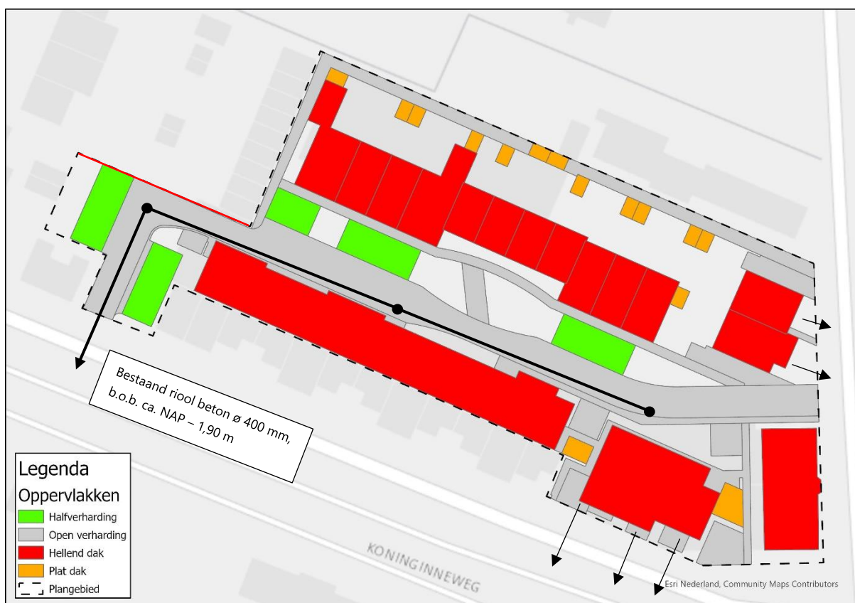
Afbeelding 12: Schetsmatige oplossing DWA
