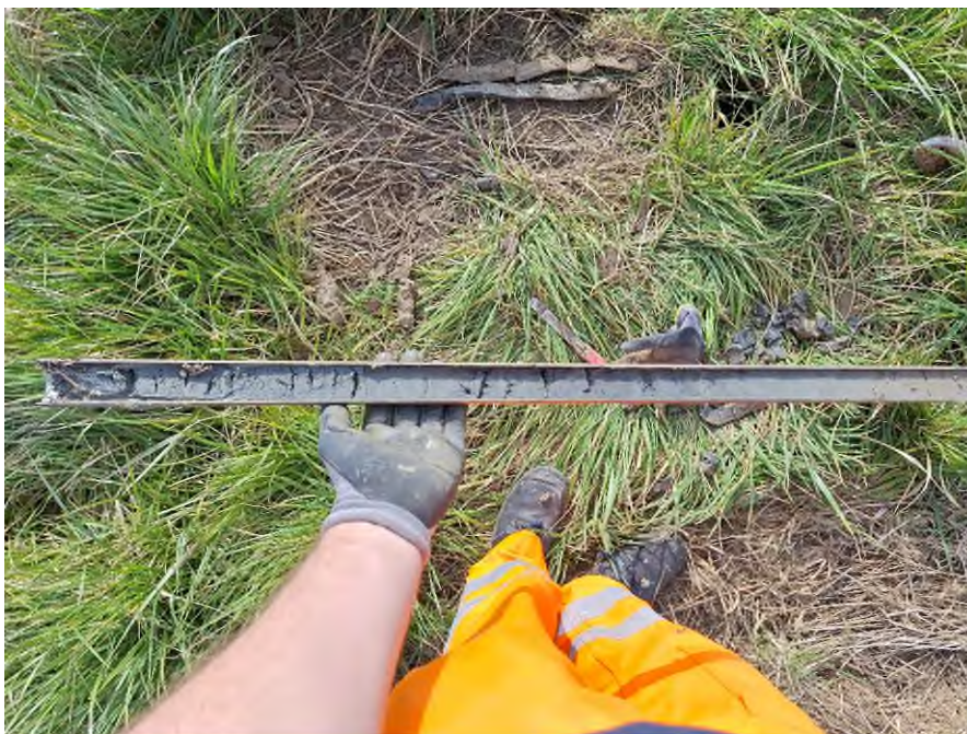
Afbeelding 26. De vermoedelijke kwelderafzetting uit boring 70 in de gutsboor. In deze laag zijn geen kleinere kleilagen aangetroffen en werd een geleidelijke verslapping waargenomen.
