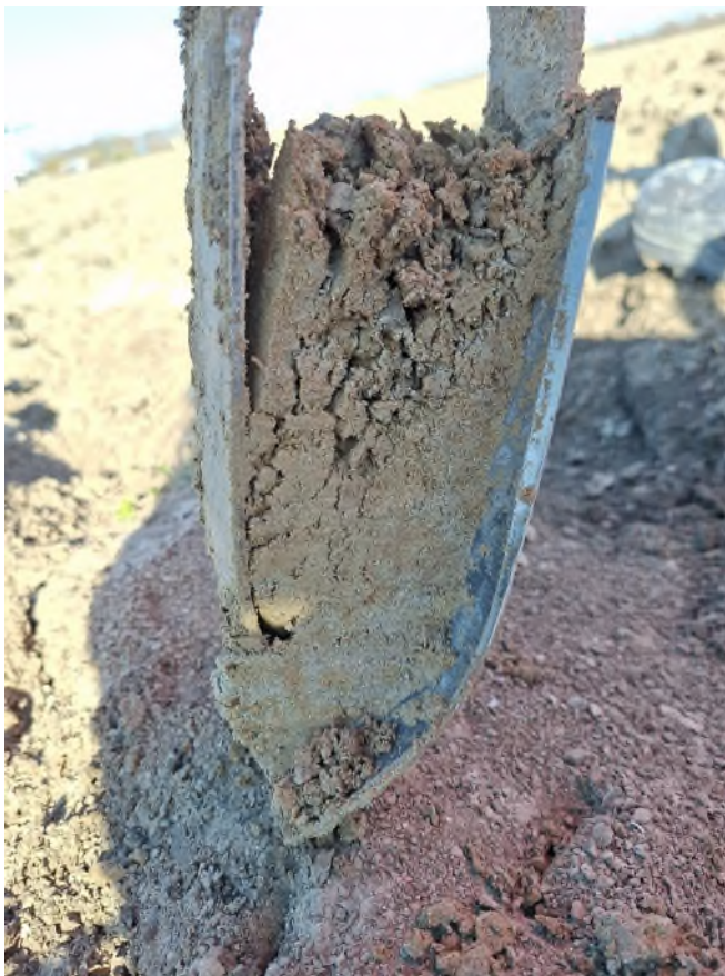
Afbeelding 25. Edelmanboor met grond uit boring 037. In deze boringen was de grens tussen klei met zandinsluitingen/brokken en een meer gelaagd, natuurlijk pakket waar te nemen. Gezien de onduidelijkheid kon de grens in veel boringen niet duidelijk worden herkend.
