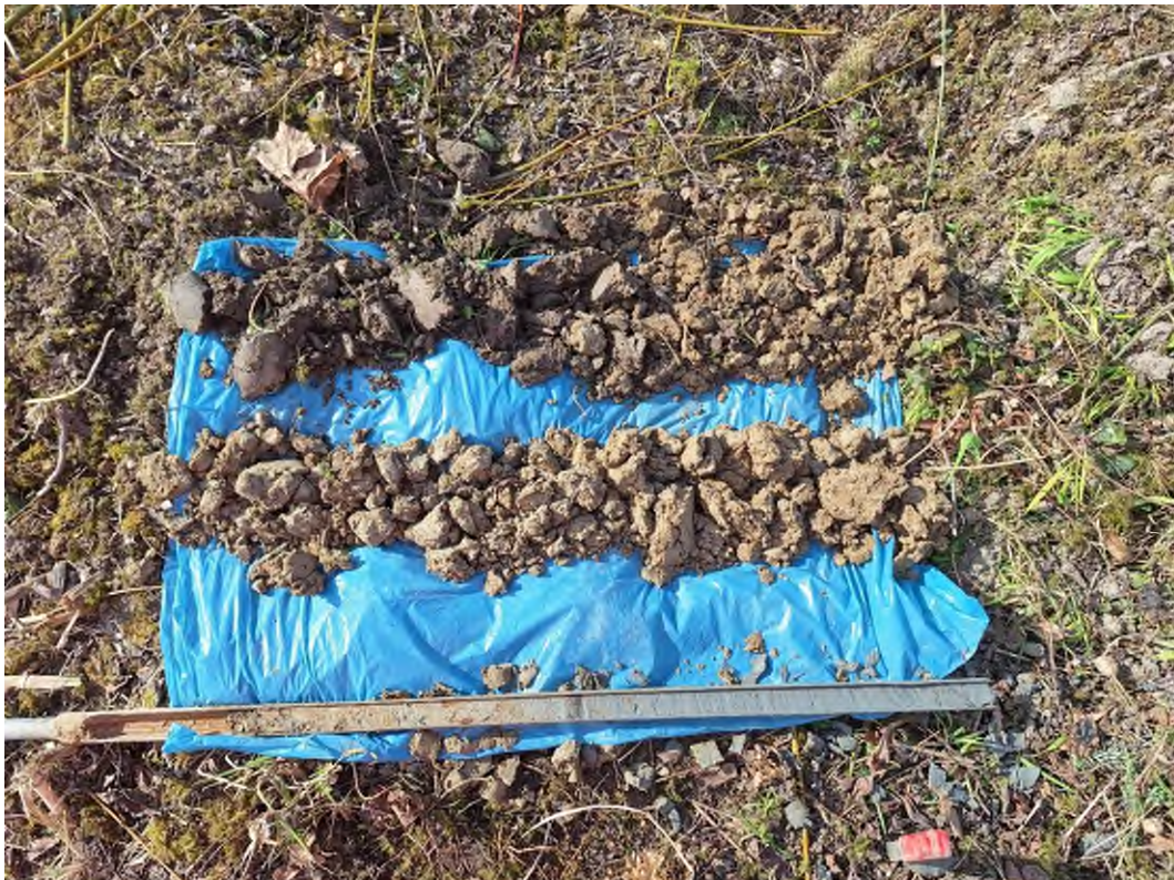
Afbeelding 24. Bodemopbouw van boring 31. In de guts is een gelaagd pakket te zien met een enkel donker humeus bandje erin.
