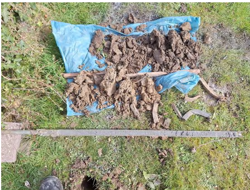
Afbeelding 27. Opgeboorde grond uit boring 70. In de gutsboor is nog net de grens tussen de kwelderafzetting en het gelaagde pakket waar te nemen (180 cm -mv).
