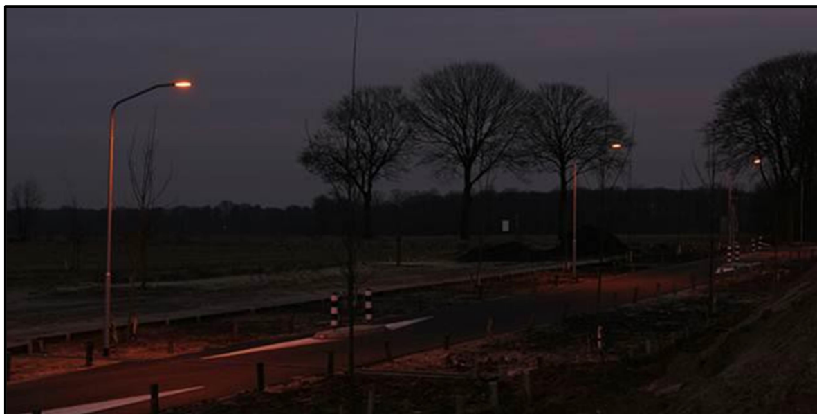
Lichthinder voor vleermuizen kan aanzienlijk worden beperkt door de toepassing van amberkleurige UV-vrije ledlampen (de Batlamp), lagere lichtmasten en een scherpe afsnede van de lichtinval.
