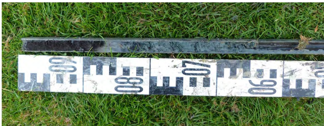
Afbeelding 19. Voorbeeld in het midden van de compacte blauwgrijze klei boven het veenniveau.
