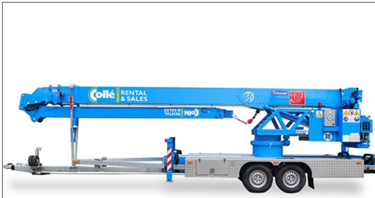
Voorbeeld van een lichte, mobiele kraan. Geschikt voor aanreiken dakpannen, gevelbekleding, kozijnen en glas.
