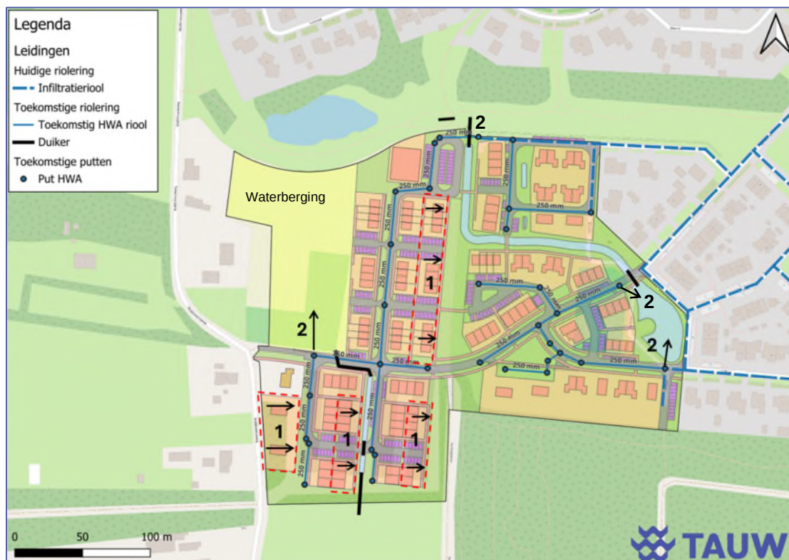
Figuur 5.6 Structuur toekomstige HWA-rivier (nummers "1": panden wateren af op groenstroken, nummers "2": lozingspunten hwa-rivier)
