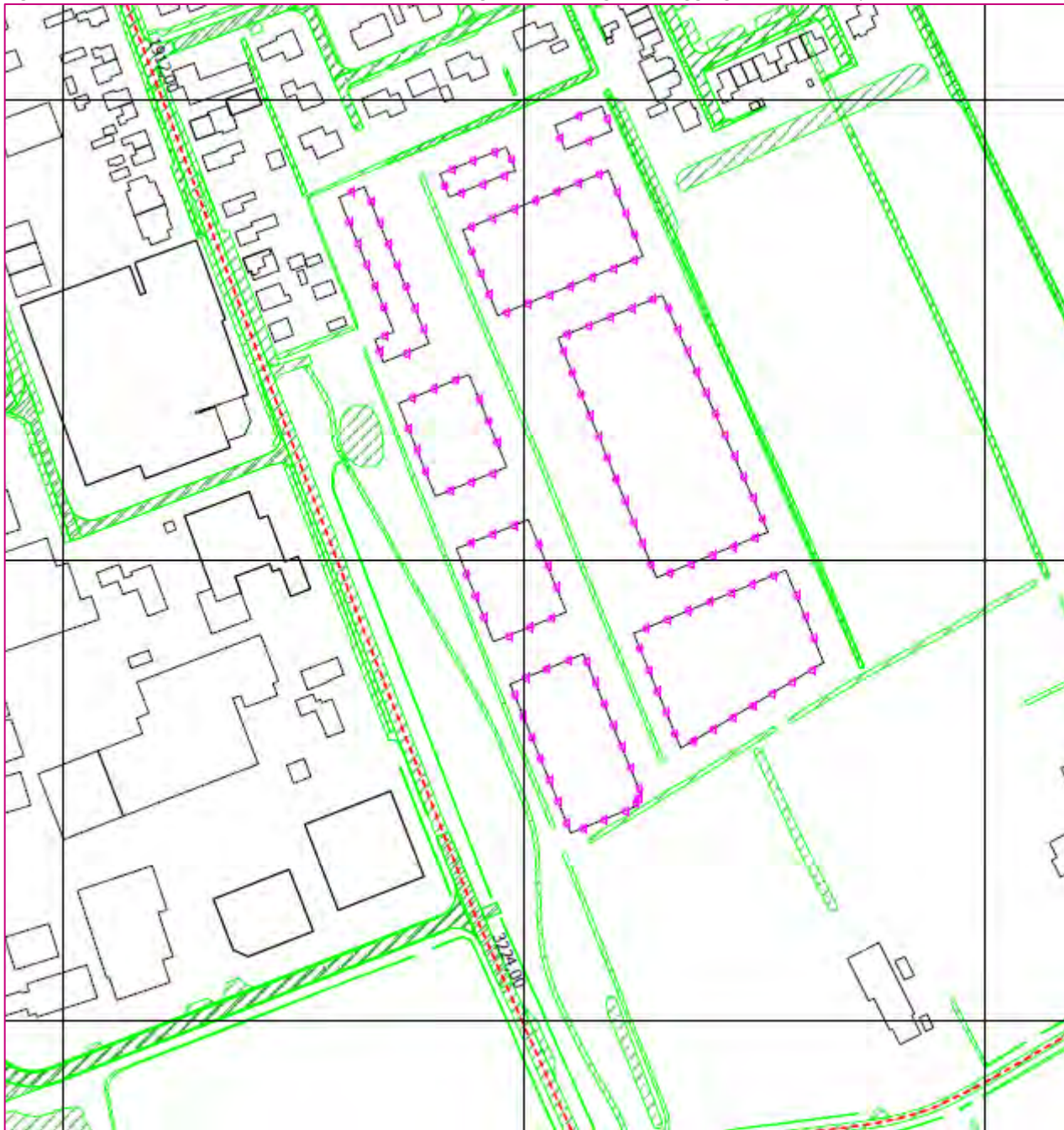
Figuur 4: akoestisch rekenmodel met de ingevoerde wegen en ligging reken-/toetspunten
