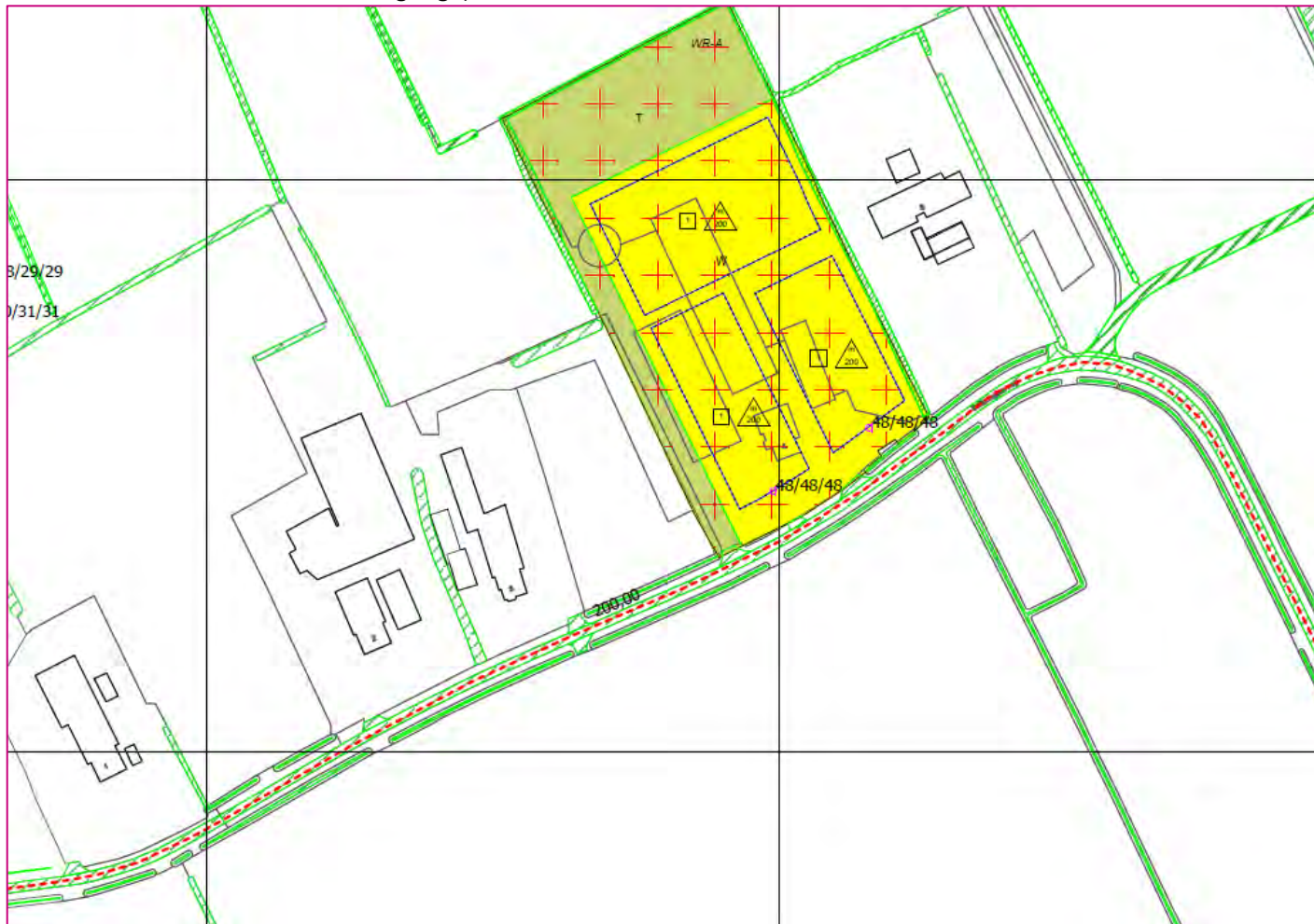
Figuur 6: overzicht van de berekende geluidbelasting L_{den} in dB vanwege de Buitenhuizerweg (inclusief 5 dB aftrek op basis van artikel 110g Wgh)
