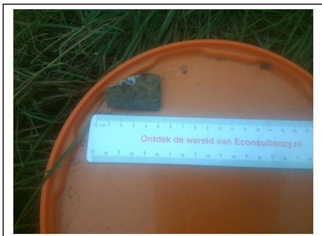
Foto 5. Asbestverdacht materiaal sleuf 104
