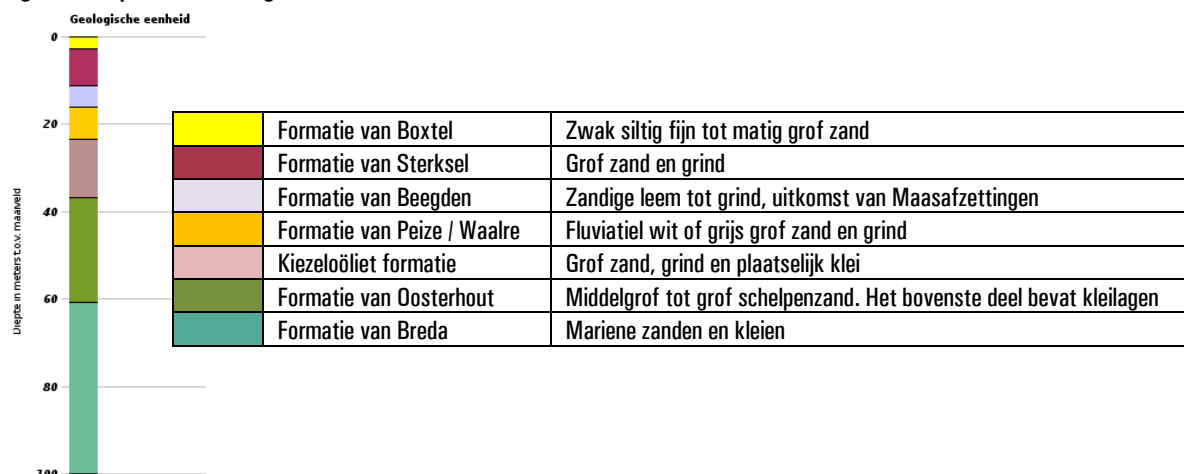
Figuur A: opbouw ondergrond.
