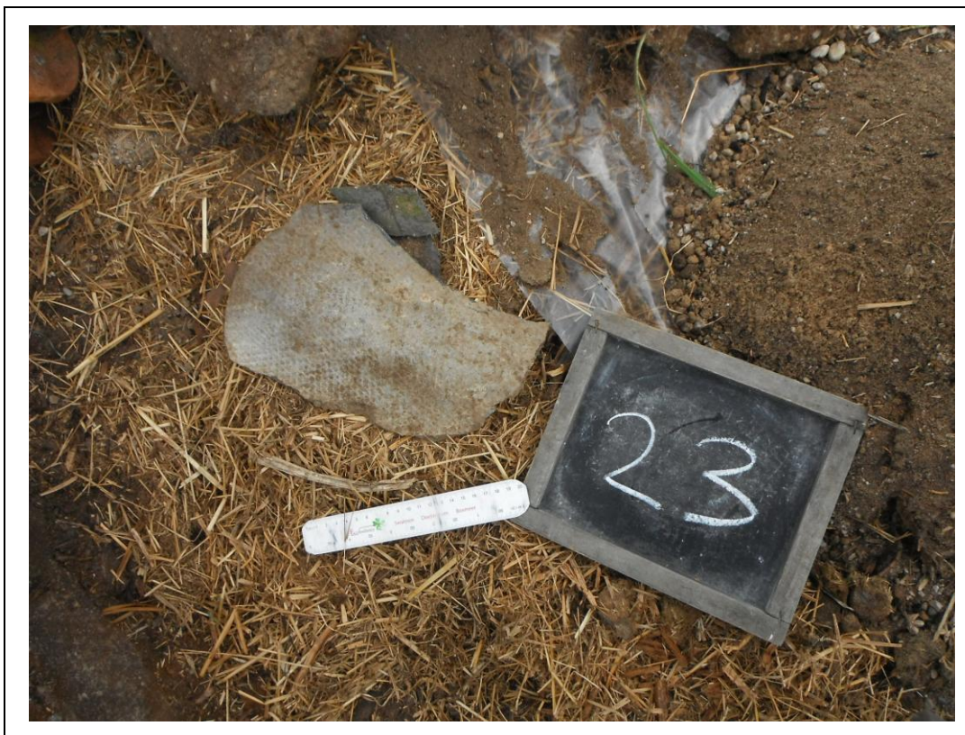
Aangetroffen asbestverdacht materiaal (ASB-1) ter plaatse van gat 23.
