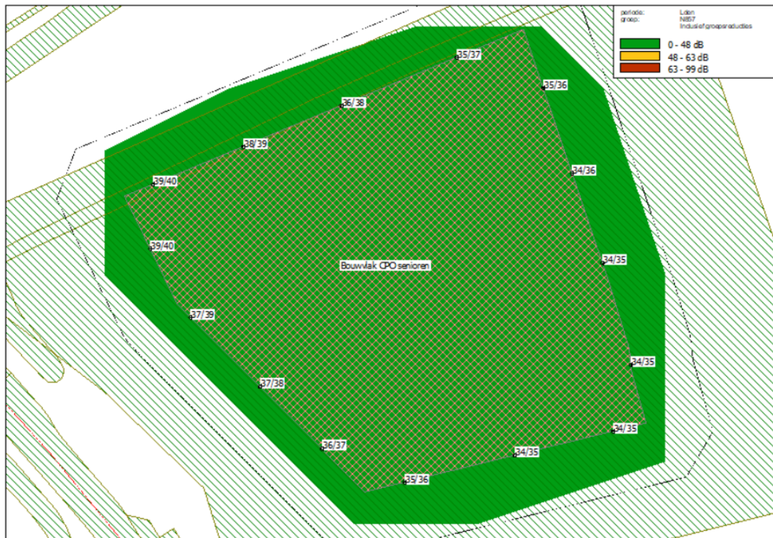
Figuur 4.2 Weergave geluidbelasting N857 (50 km/uur) op 1,5 m hoogte (inclusief aftrek art. 110g Wet geluidhinder; groen: lager dan 48 dB, oranje: tussen 48 en 63 dB en rood boven 63 dB)
