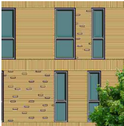
Terughoudend gevelbeeld door relatief smalle ramen en (fraai geperforeerde) metalen panelen voor de balkons
