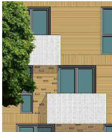
Terughoudend gevelbeeld door relatief smalle ramen en (fraai geperforeerde) metalen panelen voor de balkons
