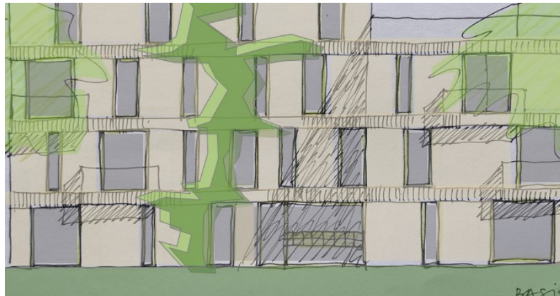
Aan de Parklaan zijde is bewust gekozen voor een vrij gesloten gevelbeeld waardoor het bezwaar 'inkijk/ privacy' zal worden weggenomen
