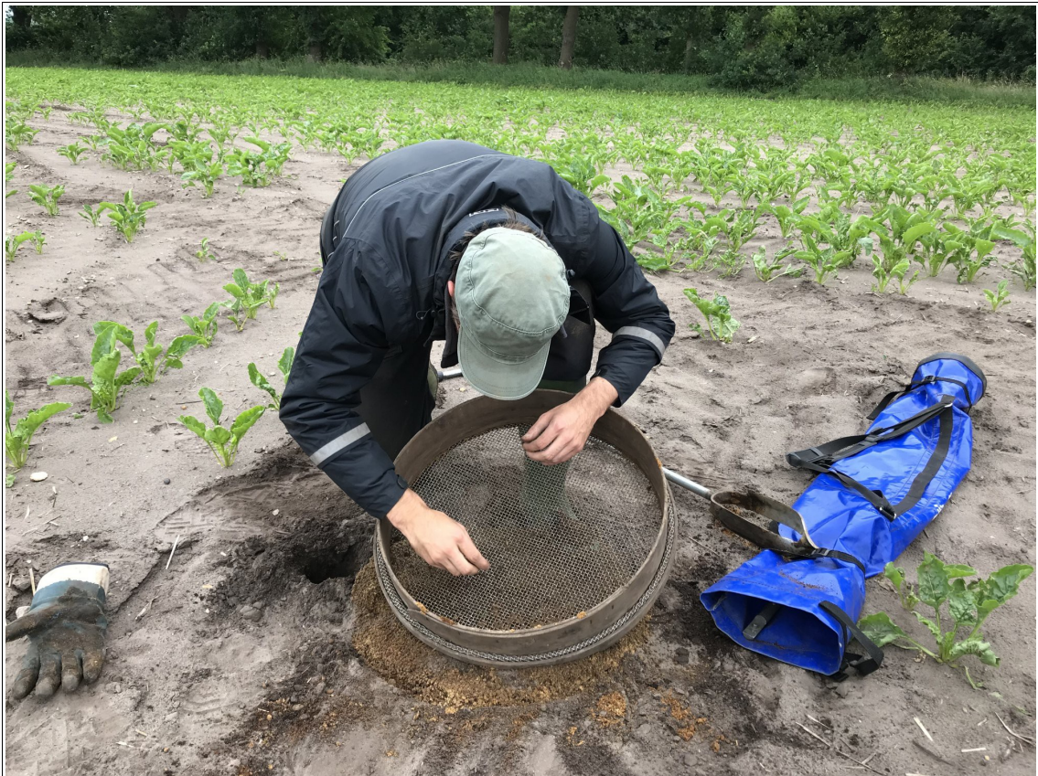
Figuur 18. Borger, Zonnepark Daalkampen: Foto van het zeven van de opgeboorde grond. De maaswijdte van de zeef is 4mm.
