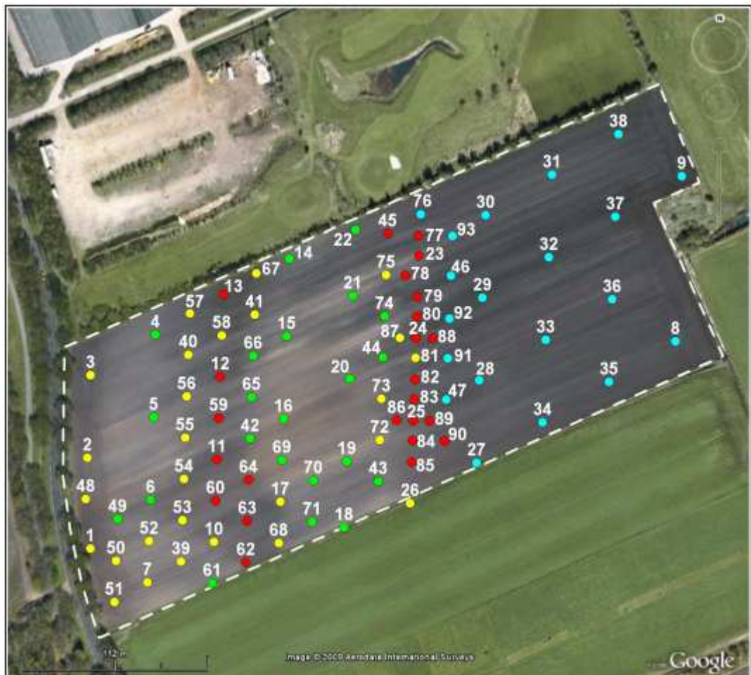
Afbeelding 4. Exloo, Golfpark Valtherweg: boorpuntenkaart. De onderbroken witte lijn geeft de begrenzing van het onderzoeksgebied weer, de genummerde punten de ligging van de 93 boringen. De betekenis van de kleuren: rood = gepodzoleerd zand afgedekt door veen, geel = restant podzolebodem aanwezig, groen = podzolebodem volledig verstoord, blauw = zand niet gepodzoleerd. Bron: Bongers, 2009.
