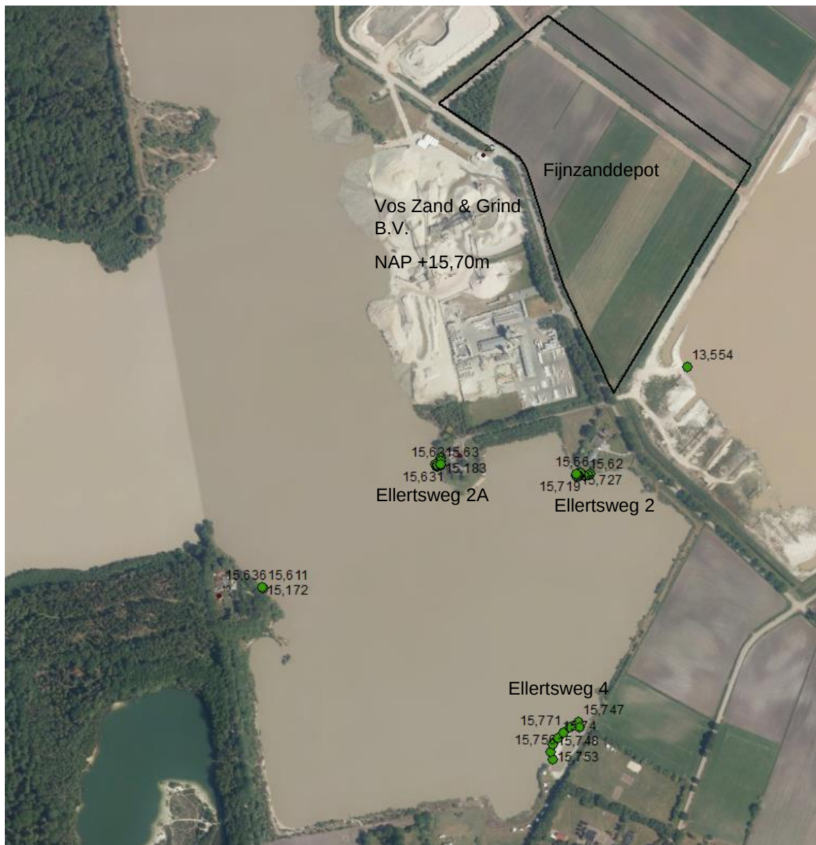
Figuur 2-3. Ingemeten hoogten ter plaatse van omliggende belangen
