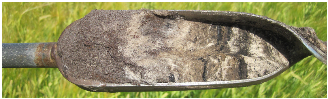
Figuur 11: Valthermond, Dreef: boormonster boring 40 van 40 tot 47 centimeter beneden maaiveld. Het monster bestaat uit geërodeerd zand afgewisseld met dunne veenlagen.
