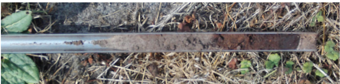
Figuur 8: Buinerveen, Zonnepark Paardetangendijk: Foto van een boorkern met een restant veen op de C-horizont (rechts).
