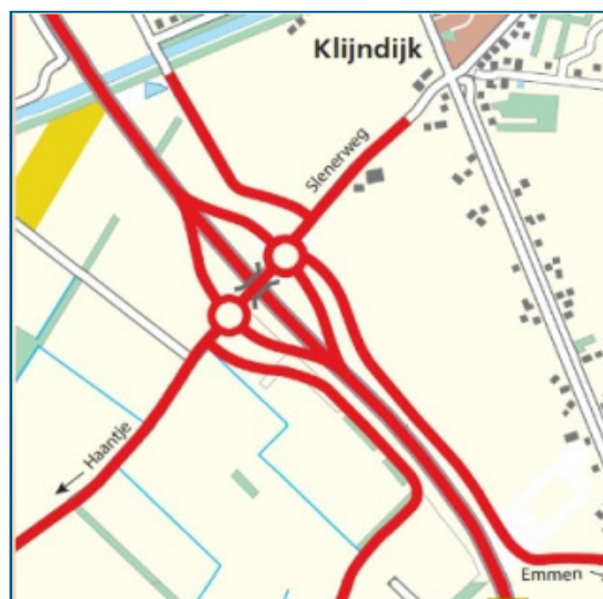
Figuur 2 Voorkeursvormgeving aansluiting Slenerweg - N34, inclusief parallelweg
