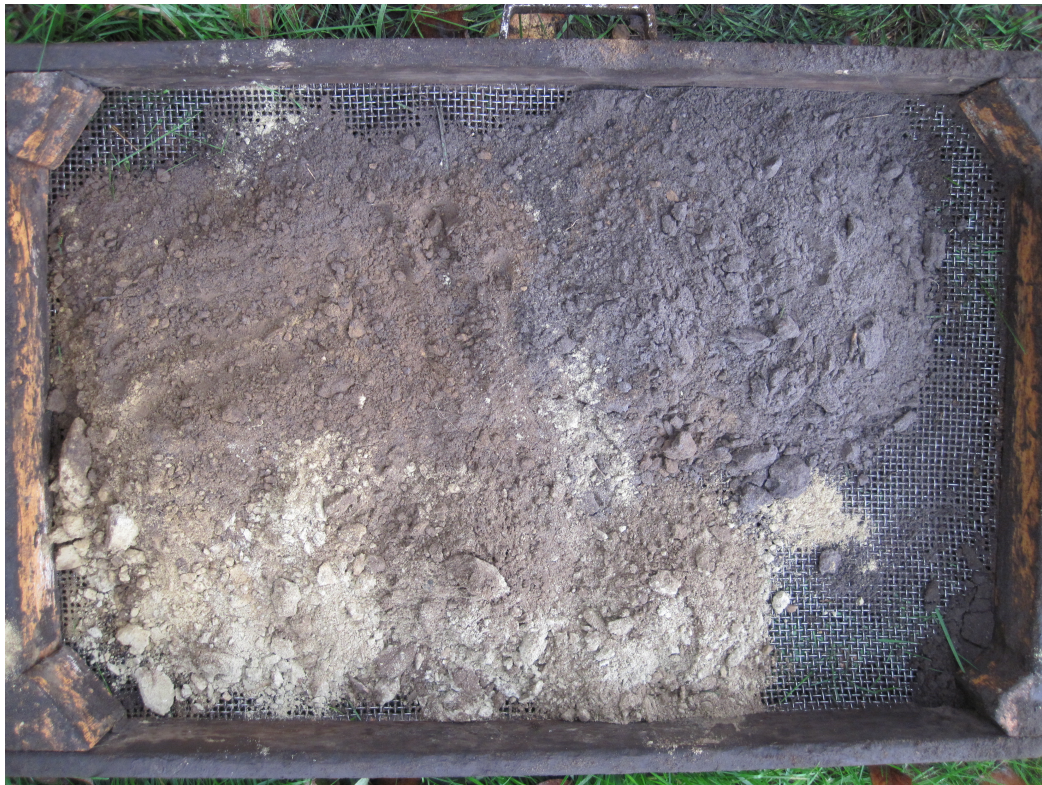
Figuur 7: Rolde, Zuides: foto van het verzamelde grondmonster in de zeef van boring 6. De grijze kleur van de bouwvoor, het vaalbruine van de eslaag en het schone gele zand zijn duidelijk te zien.
