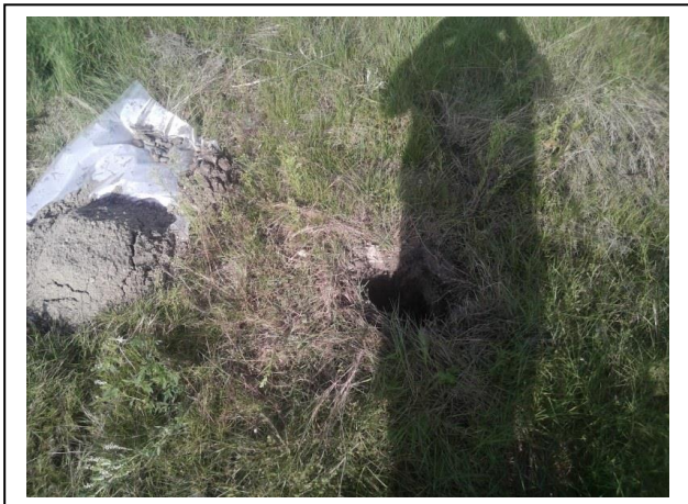
Foto 13. Opgegraven en gezeefd materiaal inspectiegat C11
