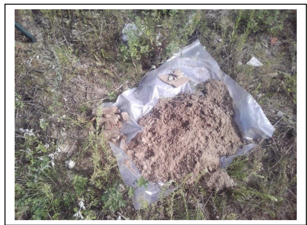
Foto 12 Opgegraven materiaal inspectiegat C10 (niet gezeefd)
