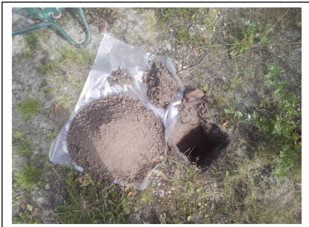
Foto 7. Opgegraven en gezeefd materiaal inspectiegat C05
