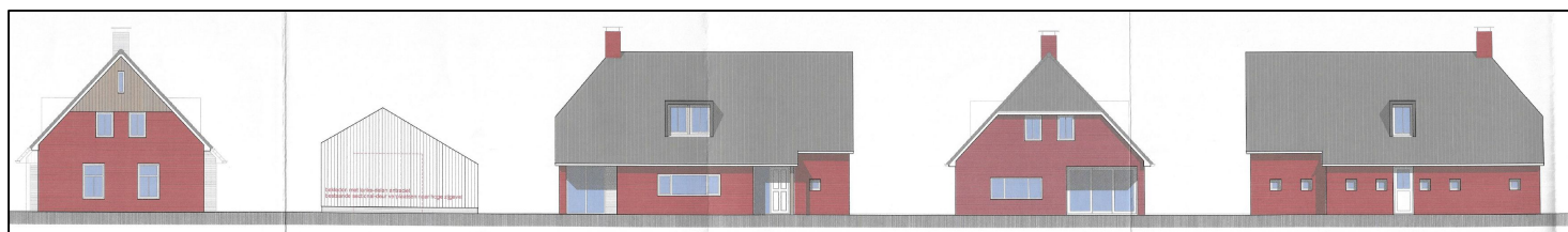
Gevelaanzichten oostelijke woning (nr. 3), van links naar rechts: zuidoostgevel, zuidwestgevel, noordwestgevel en noordoostgevel (bron: roossien architectuur-techniek)
