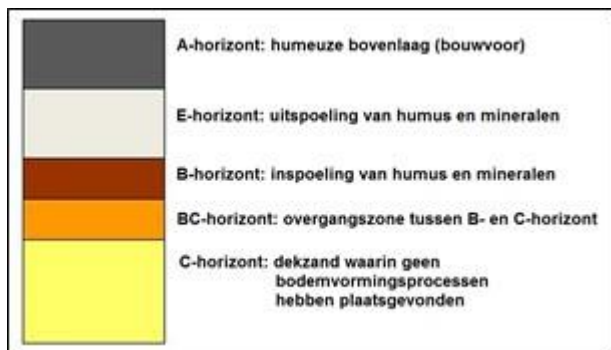
Afbeelding 3. Schematische weergave van een podzolbodem
