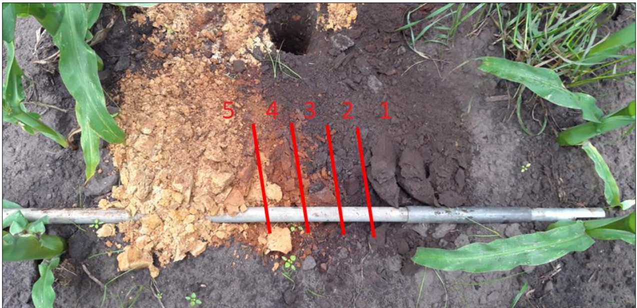
Afbeelding 15. Boorkern van boring 2 met interpretatie. 1: bouwvoor; 2: EB-horizont; 3: B-horizont; 4: BC-horizont; 5: C-horizont
