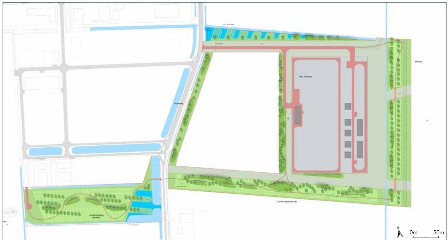
▲ Fig. 5.2 Plattegrond Schetsontwerp landschappelijke inpassing Hoogspanningsstation Zierikzee. De plattegrond is op volledig formaat toegevoegd als bijlage.
