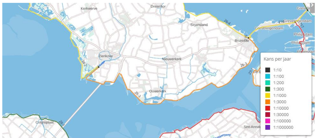
Figuur 5.1: Normering (ondergrens) dijktrajecten in de omgeving van het geplande 150 kV station Zierikzee ( www.waterveiligheidsportaal.nl ).
