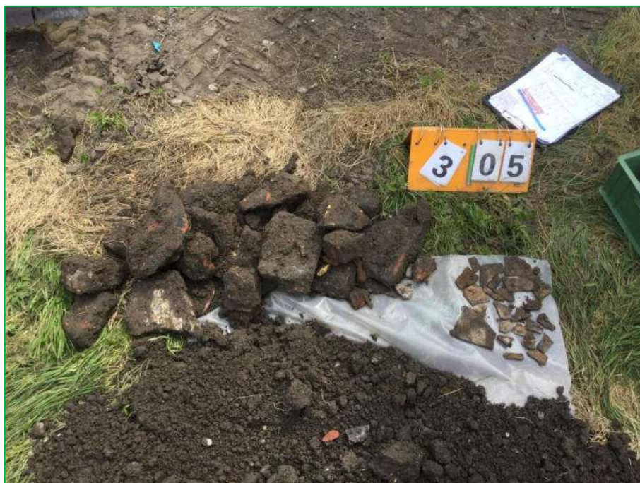
Foto 14 Asbestverdacht materiaal sleuf 305
