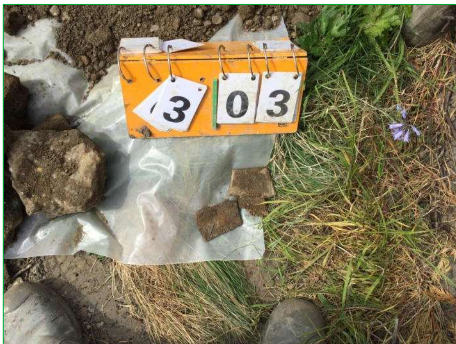
Foto 10 Asbestverdacht materiaal sleuf 303
