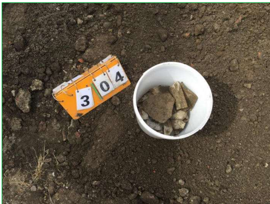
Foto 12 Asbestverdacht materiaal sleuf 304
