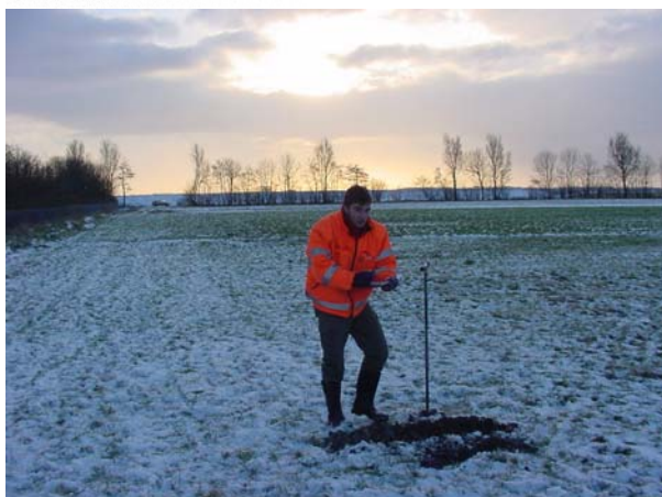
Afbeelding 8: uitvoering van een boring tijdens het karterend booronderzoek in 2003.
