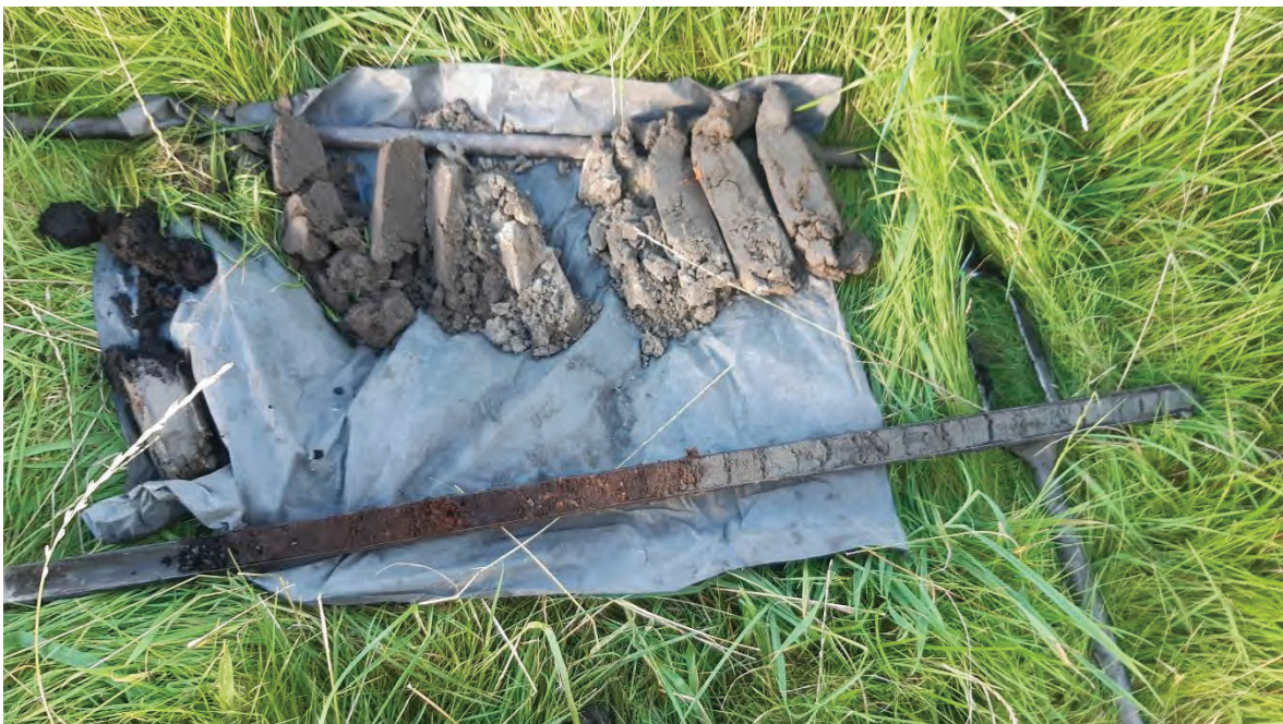
Afbeelding 15 De boorkernen van boring 4781031. Zichtbaar is hoe de opgebrachte grond tot aan het pakket Hollandveen reikt. De top van het Hollandveen is afgegraven. Bron foto: Vestigia 30 september 2021.
