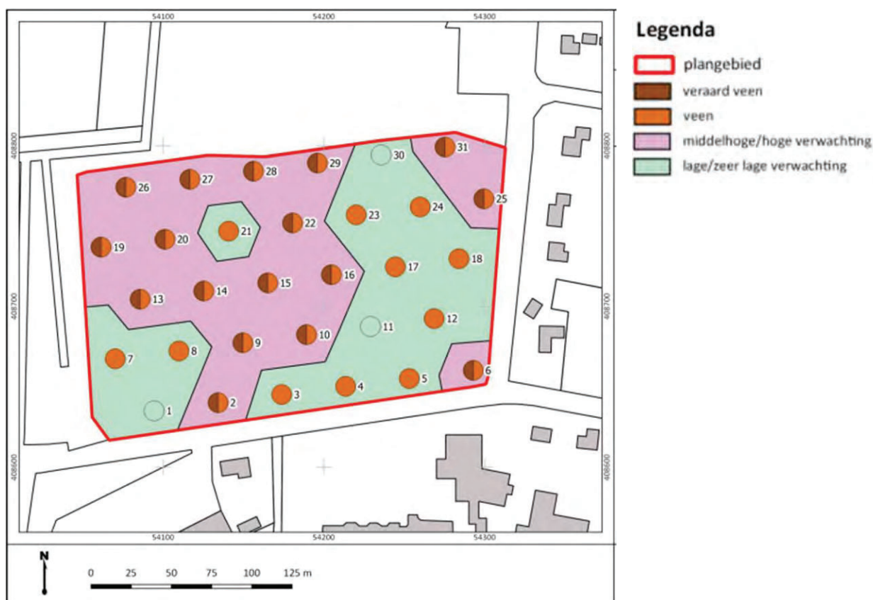
Afbeelding 5 Resultaten van het booronderzoek (Zaak ID 4004172100) in het zuidoostelijk deel van het plangebied. Bron: Wullink 2016.
