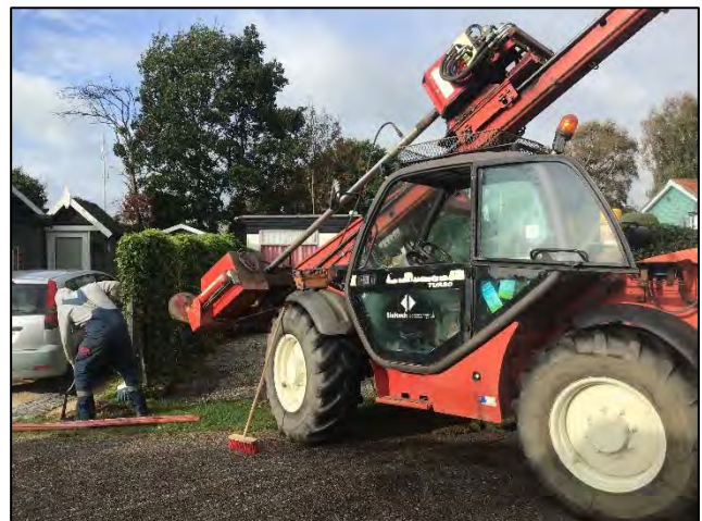
Figuur 7 Impressie boormethode en omgeving. Links: boorstelling, boven: uitpersen staalname in gootje, linksonder: beschrijven stalen in gootjes, rechtsonder: dichten boorgaten.
