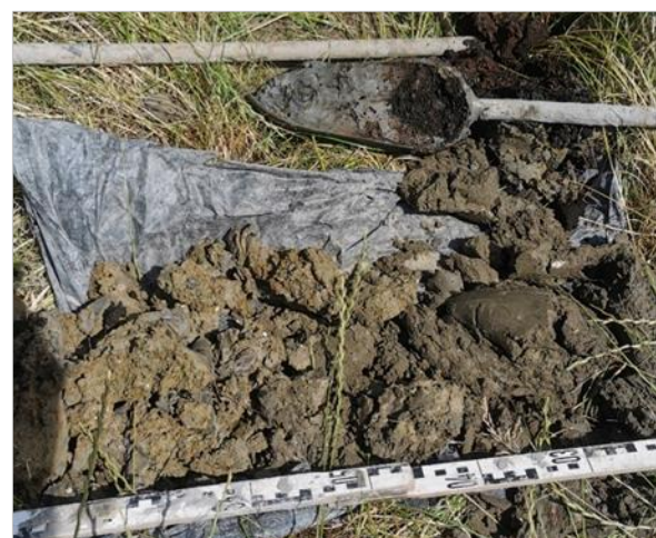
Figuur 23. De bodemlagen in boring 7. Met rechts vooraan de bouwvoor, links vooraan de bruinrijke kleilagen (Laagpakket van Walcheren), met rechtsboven deels nog in de Edelmanboor het restant van de veenlaag (Hollandveen laagpakket).
