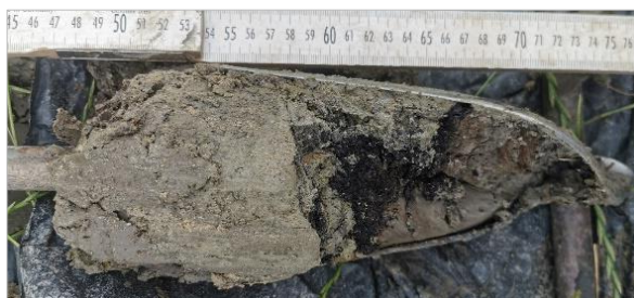
Figuur 24. Opgeboorde bodemlagen van boring 11, met links de grijze kleiige zandlaag (laagpakket van Walcheren), in het midden het restant van het gemoerneerde veenpakket (Hollandveen laagpakket) en rechts de kleiige top van de onder het veen liggende bodemlaag (laagpakket van Wormer). De top van het laagpakket van Wormer bevindt zich hier op een diepte van 62 centimeter onder maaiveld.
