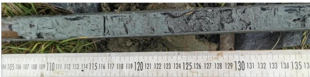
Figuur 25. De diepere bodemopbouw in boring 12. Onder de top van het Laagpakket van Wormer, die hier uit slappe blauwgrijze klei bestaat bevindt zich vanaf 115 centimeter onder maaiveld een afwisseling van grijze en blauwgrijze zand en kleilaagjes.
