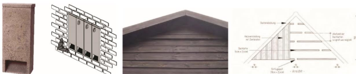
Figuur 3.8 Voorbeeld ingebouwde vleermuisverblijven
