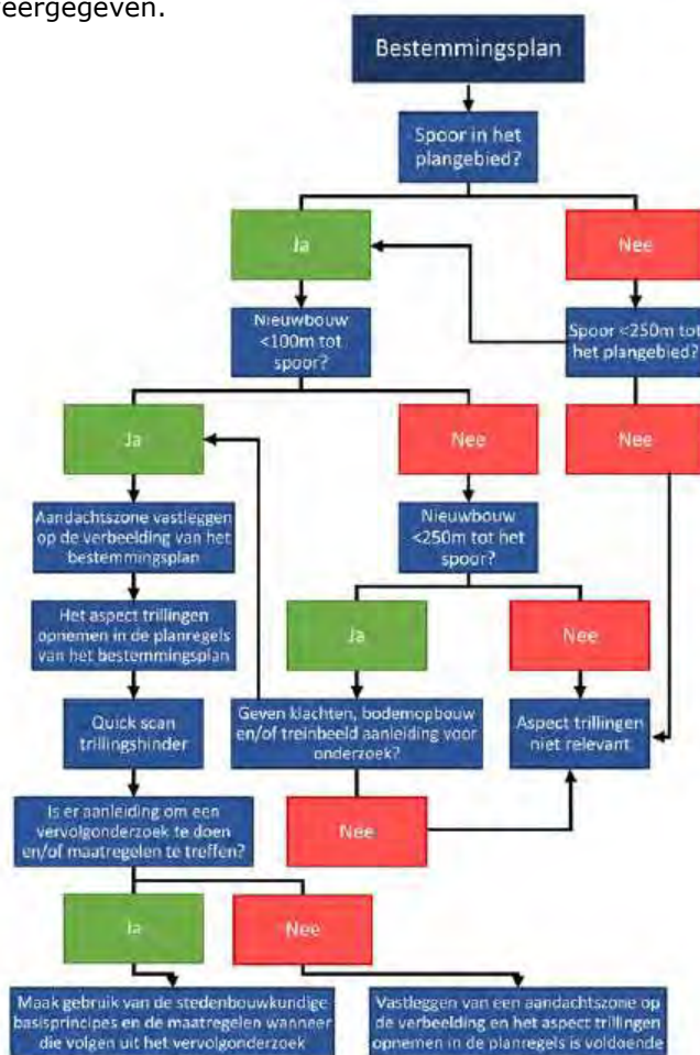
Afbeelding 3. Stroomschema Handreiking Nieuwbouw en Spoortrillingen
