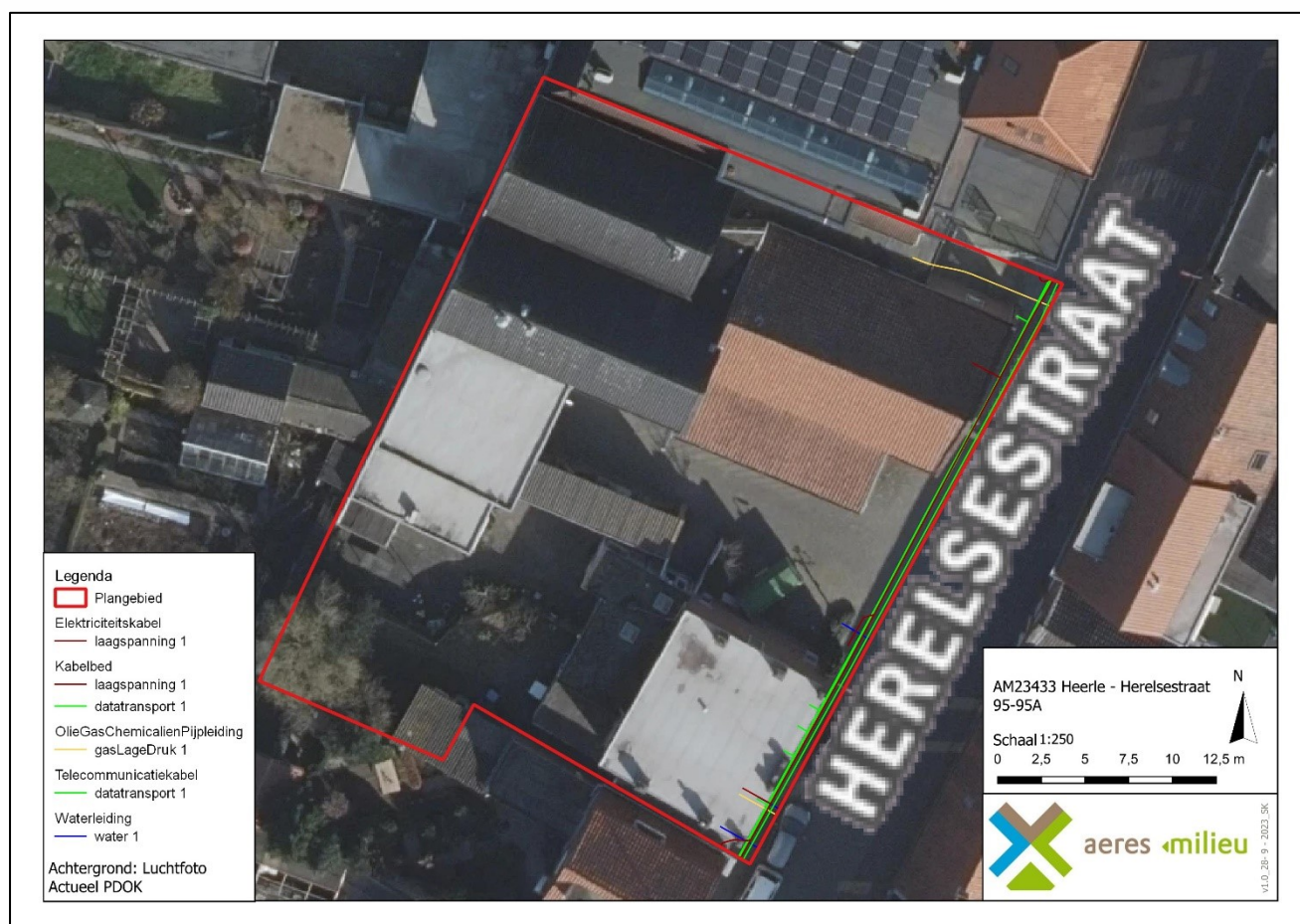
Figuur 6. Afbeelding van de te verwachten kabels en leidingen binnen het plangebied op basis van het KLIC (27 september 2023).
