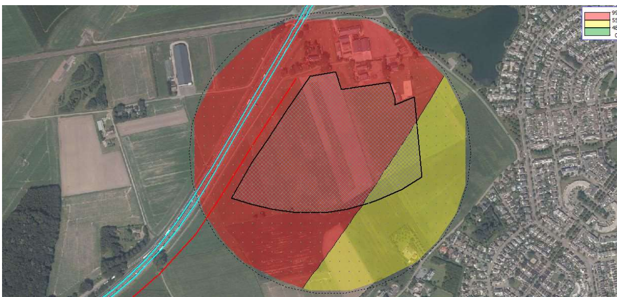
Figuur 33 Geluidcontouren A58 met bronmaatregel tweelaags ZOAB (contouren op 25 m boven maaiveld)
