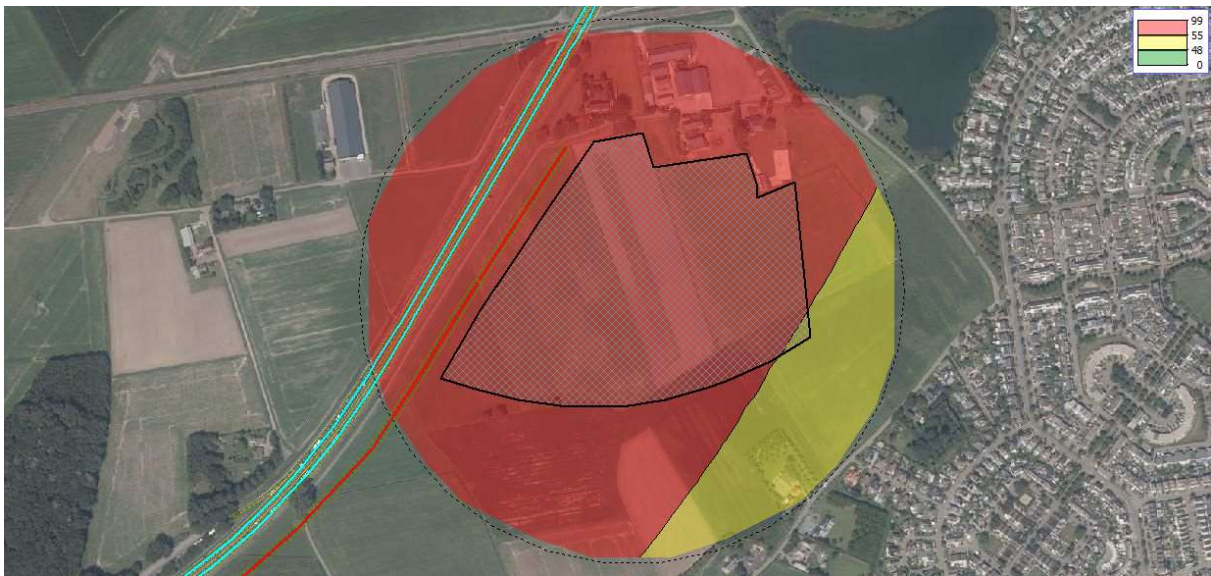
Figuur 24 Geluidcontouren A58 (contouren op 15 m boven maaiveld)
