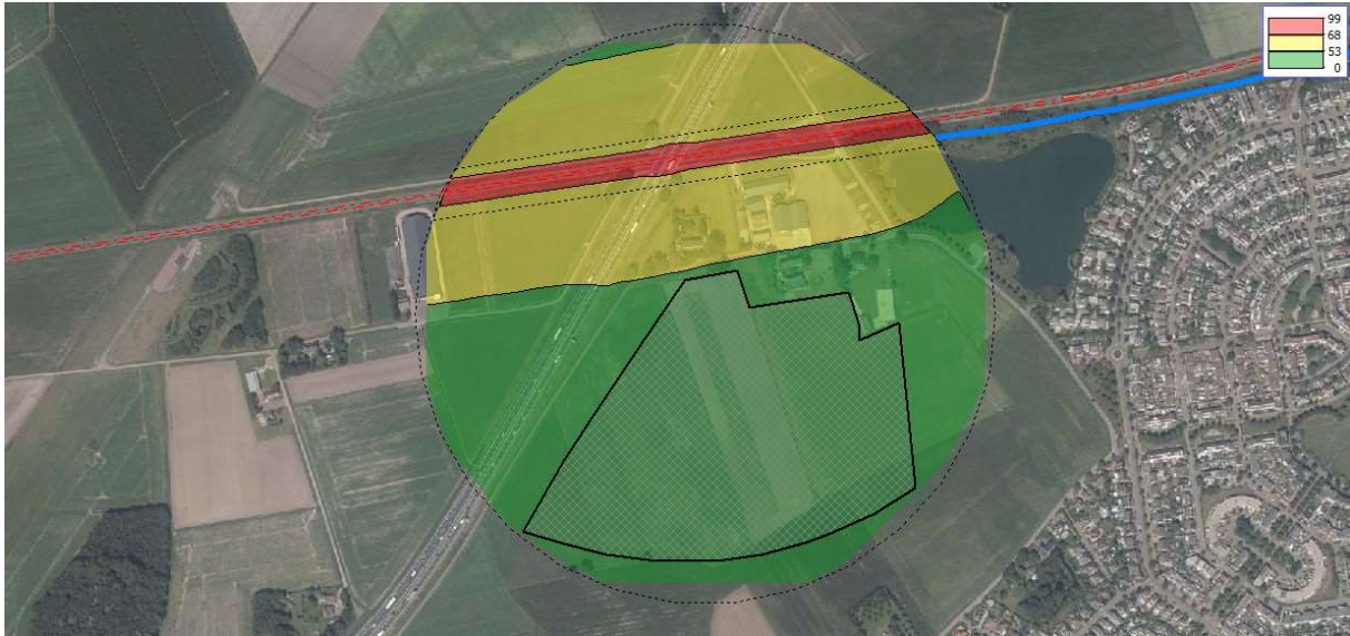
Figuur 43 Geluidcontouren spoorlijn Roosendaal – Bergen op Zoom (contouren op 1,5 m boven maaiveld)
