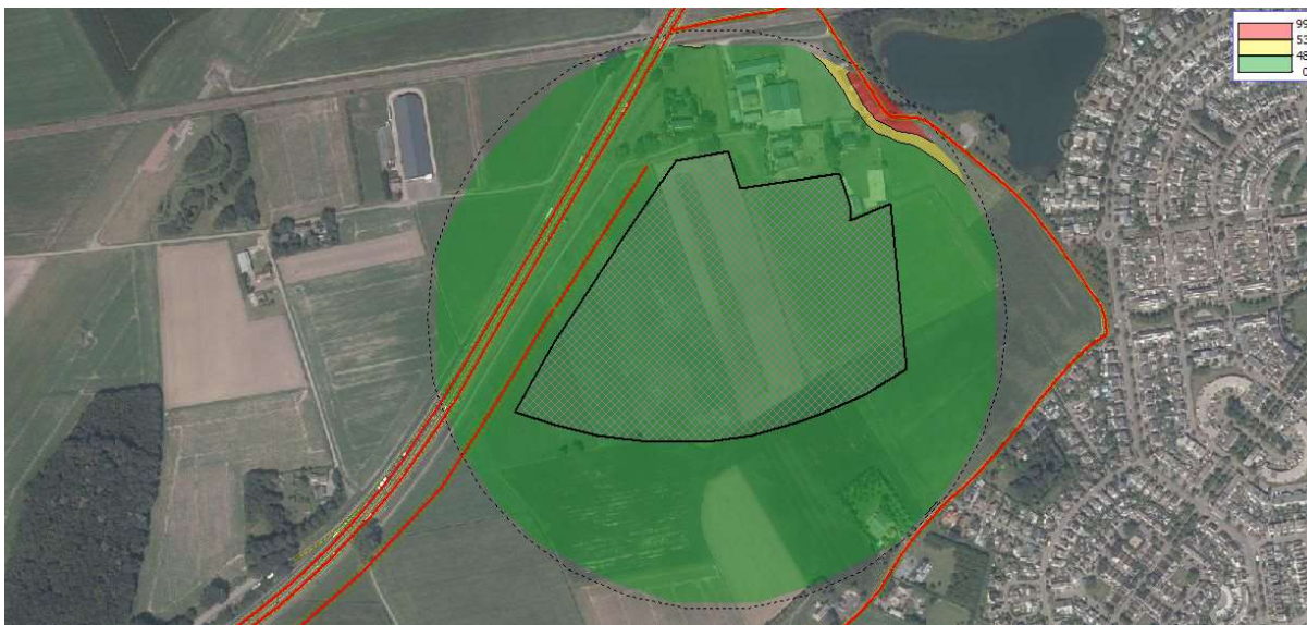
Figuur 14 Geluidcontouren Bulkenaarsestraat/Huijbergseweg (contouren op 1,5 m boven maaiveld)
