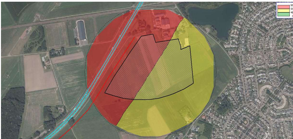
Figuur 28 Geluidcontouren A58 met bronmaatregel tweelaags ZOAB (contouren op 1,5 m boven maaiveld)
