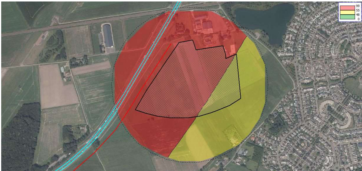
Figuur 31 Geluidcontouren A58 met bronmaatregel tweelaags ZOAB (contouren op 15 m boven maaiveld)
