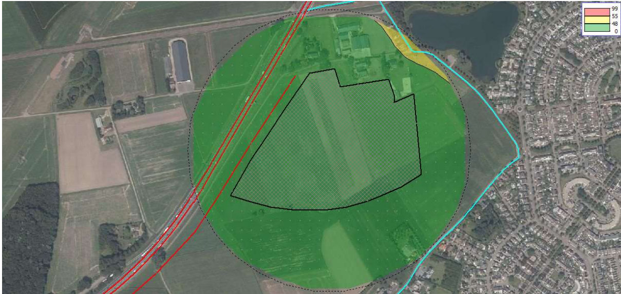
Figuur 20 Geluidcontouren Bulkenaarsestraat/Huijbergseweg (contouren op 30 m boven maaiveld)
