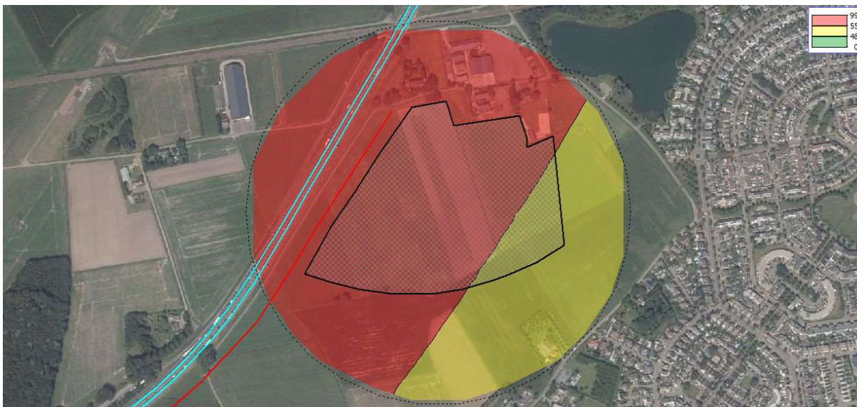
Figuur 32 Geluidcontouren A58 met bronmaatregel tweelaags ZOAB (contouren op 20 m boven maaiveld)
