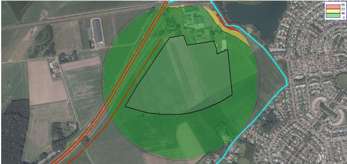
Figuur 16 Geluidcontouren Bulkenaarsestraat/Huijbergseweg (contouren op 10 m boven maaiveld)
