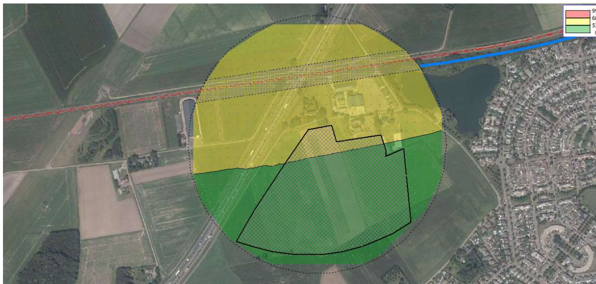
Figuur 49 Geluidcontouren spoorlijn Roosendaal – Bergen op Zoom (contouren op 30 m boven maaiveld)
