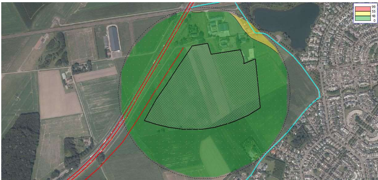
Figuur 19 Geluidcontouren Bulkenaarsestraat/Huijbergseweg (contouren op 25 m boven maaiveld)
