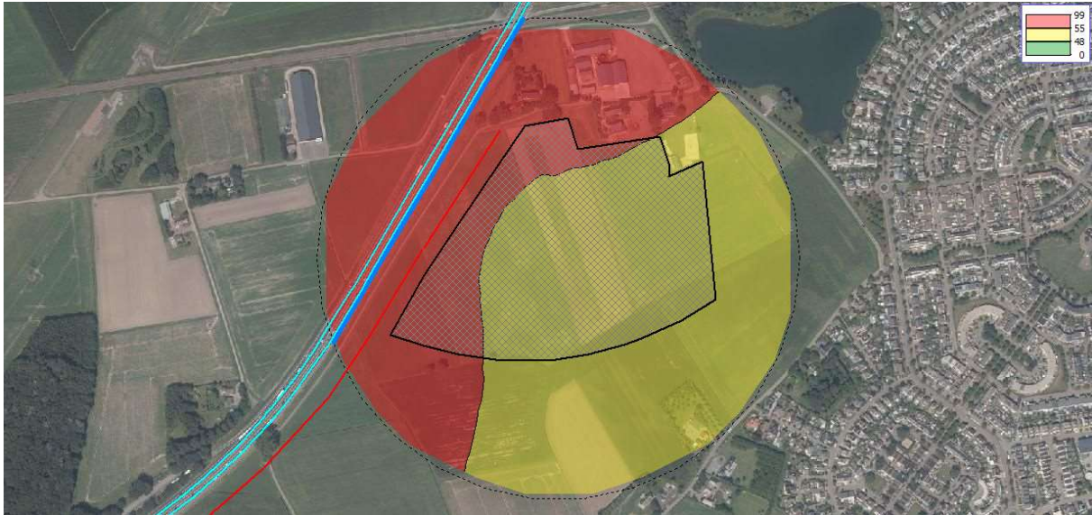
Figuur 36 Geluidcontouren A58 met geluidscherm 3m hoog en 570 m lang (contouren op 5 m boven maaiveld)
