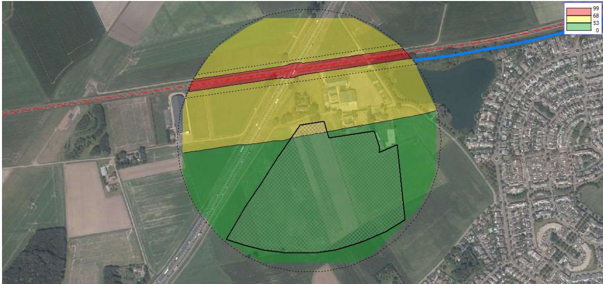
Figuur 45 Geluidcontouren spoorlijn Roosendaal – Bergen op Zoom (contouren op 10 m boven maaiveld)
