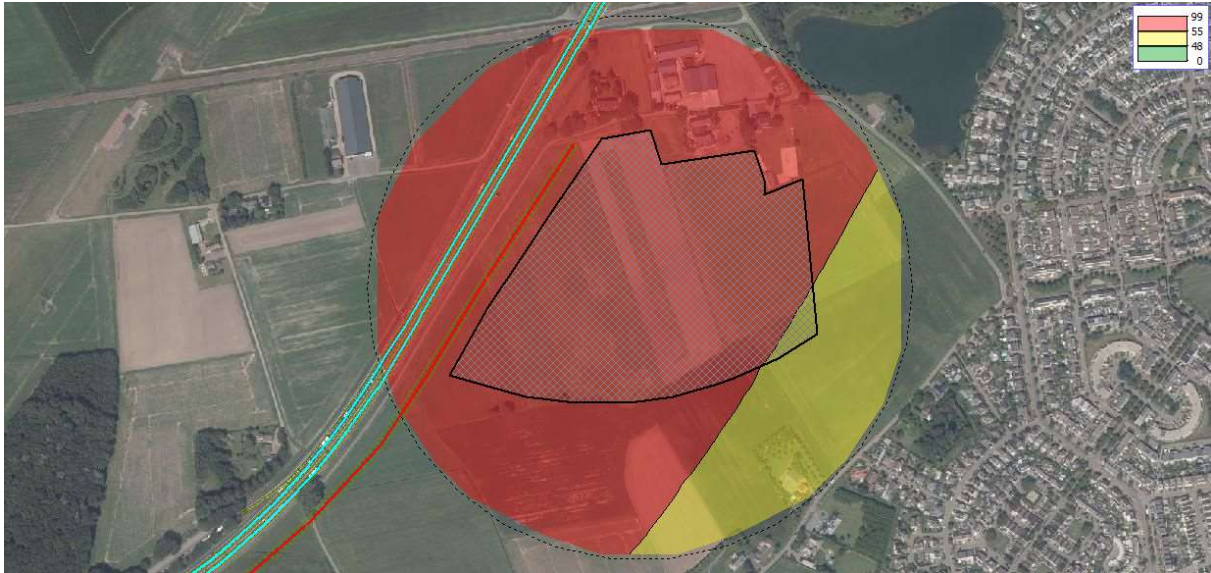
Figuur 23 Geluidcontouren A58 (contouren op 10 m boven maaiveld)
