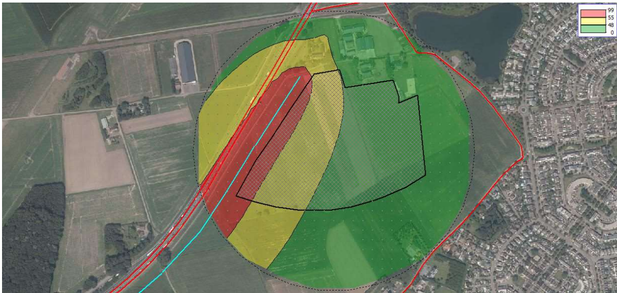
Figuur 12 Geluidcontouren verbindingsweg (contouren op 25 m boven maaiveld)
