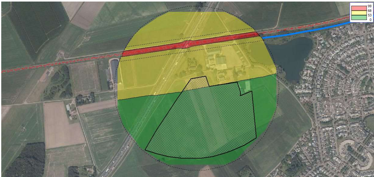
Figuur 46 Geluidcontouren spoorlijn Roosendaal – Bergen op Zoom (contouren op 15 m boven maaiveld)
