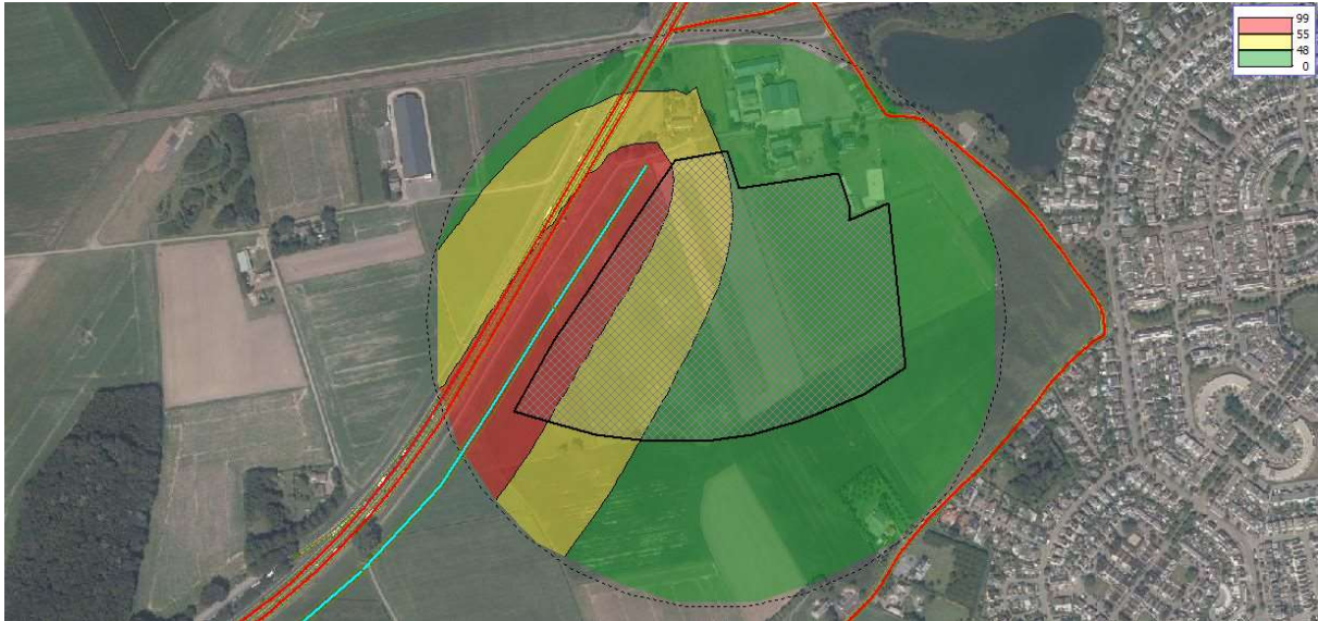
Figuur 10 Geluidcontouren verbindingsweg (contouren op 15 m boven maaiveld)
