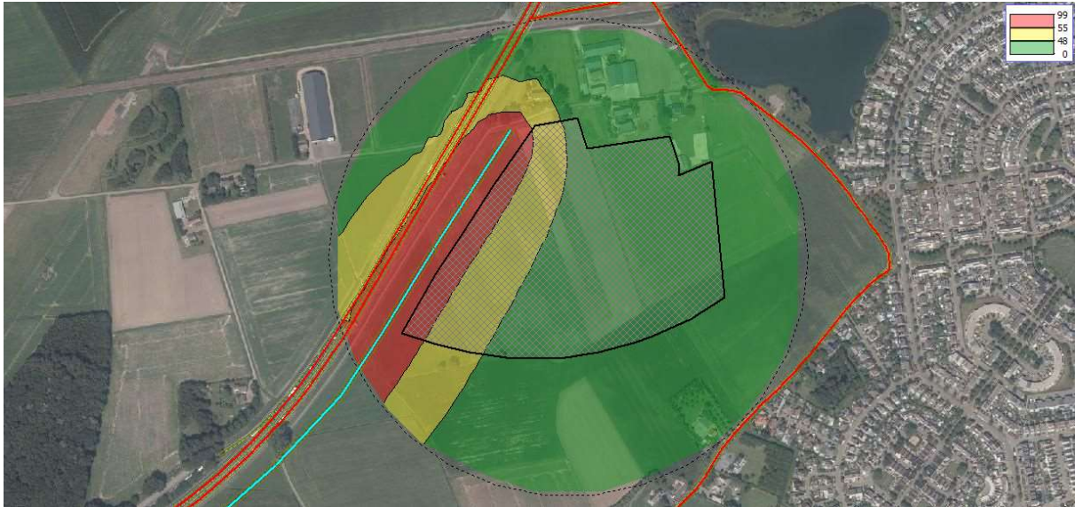
Figuur 8 Geluidcontouren verbindingsweg (contouren op 5 m boven maaiveld)
