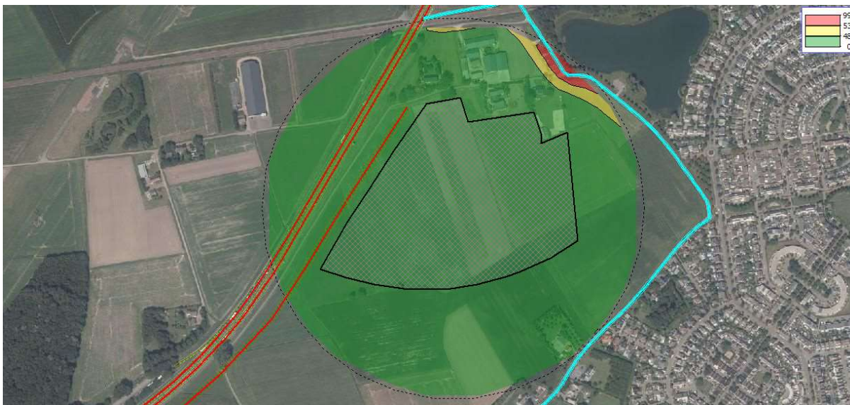
Figuur 15 Geluidcontouren Bulkenaarsestraat/Huijbergseweg (contouren op 5 m boven maaiveld)
