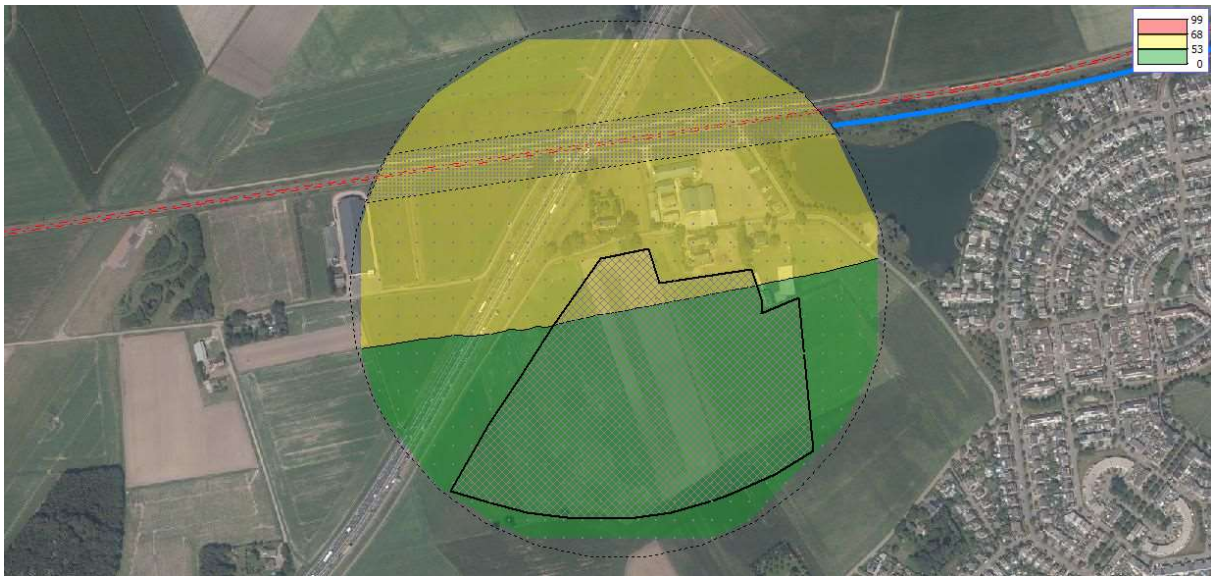
Figuur 48 Geluidcontouren spoorlijn Roosendaal – Bergen op Zoom (contouren op 25 m boven maaiveld)
