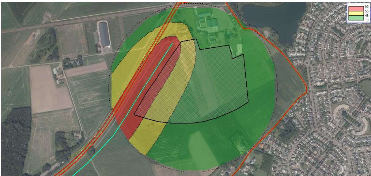
Figuur 9 Geluidcontouren verbindingsweg (contouren op 10 m boven maaiveld)
