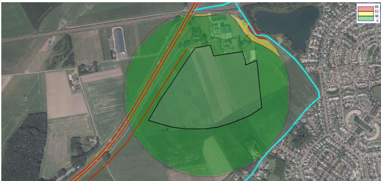
Figuur 17 Geluidcontouren Bulkenaarsestraat/Huijbergseweg (contouren op 15 m boven maaiveld)
