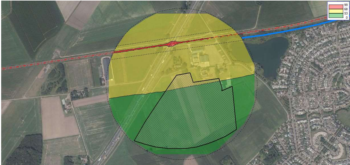
Figuur 47 Geluidcontouren spoorlijn Roosendaal – Bergen op Zoom (contouren op 20 m boven maaiveld)
