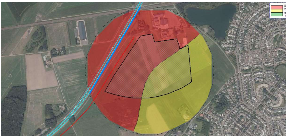
Figuur 39 Geluidcontouren A58 met geluidscherm 3m hoog en 570 m lang (contouren op 20 m boven maaiveld)
