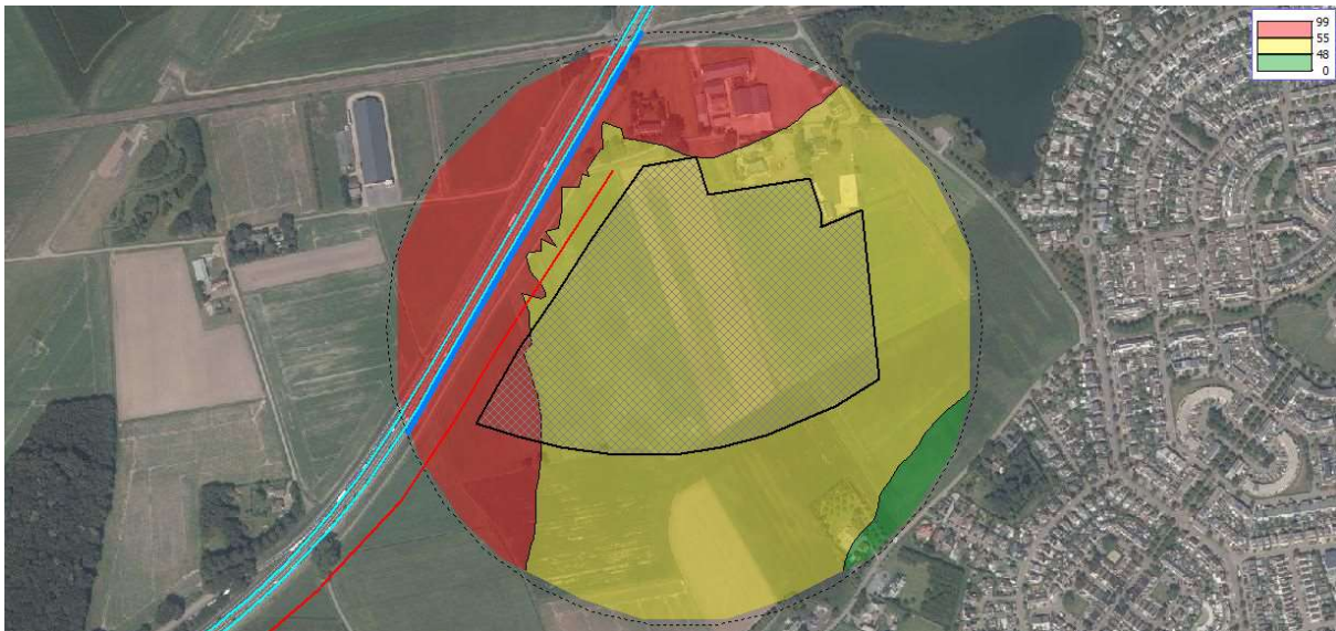
Figuur 35 Geluidcontouren A58 met geluidscherm 3m hoog en 570 m lang (contouren op 1,5 m boven maaiveld)
