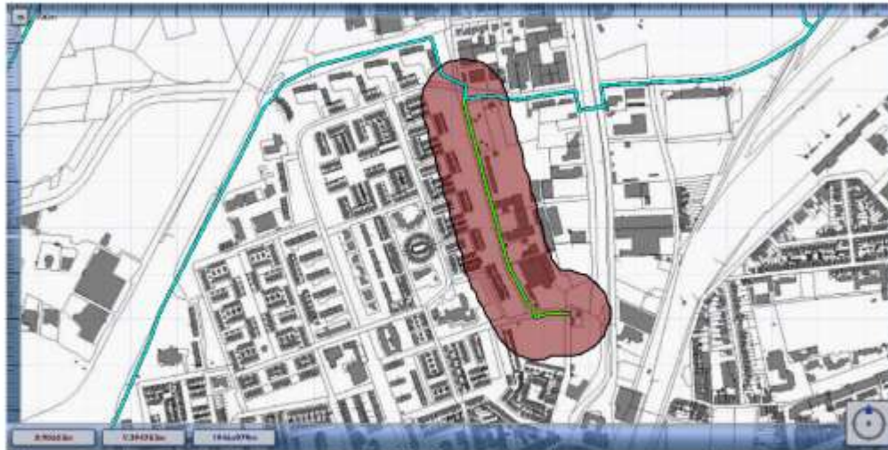
Figuur 5: Kilometer leiding van de Z-529-05 met het hoogste groepsrisico (groen). In het lichtblauw is de gehele leiding aangegeven. De rode contour hieromheen is het invloedsgebied van de leiding.
