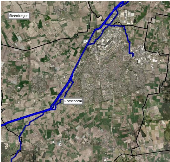
Figuur 4: Ligging overige buisleidingen (Stikstof, waterstof, zuurstof, ethyleen en propyleen) buitengebied Roosendaal Nispen
