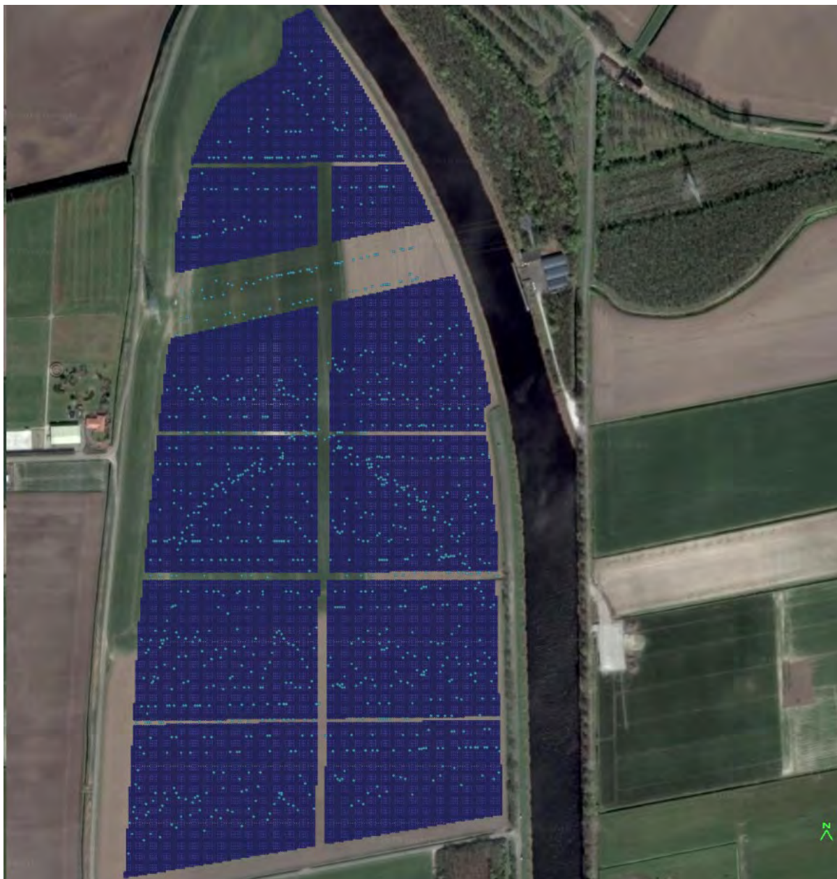
Figuur 4.2: Opstelling zonnepanelen met bestaande hoogspanningsverbindingen
