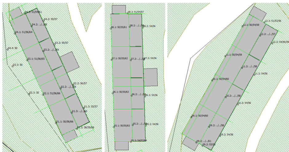
Figuur 5.1.1 Geluidbelasting vanwege de Rijkswegen bouwnummers 1 t/m 12
