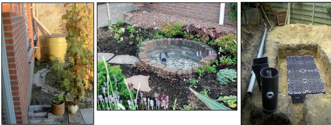
Figuur 16: Voorbeelden van infiltratiemogelijkheden
