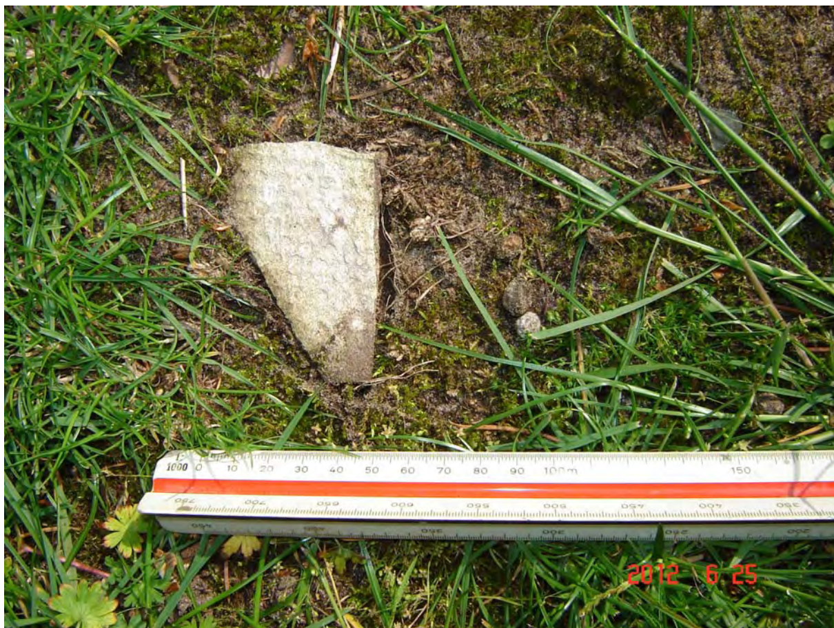
Foto ;asbest plaatmateriaal (maaiveld B6)
