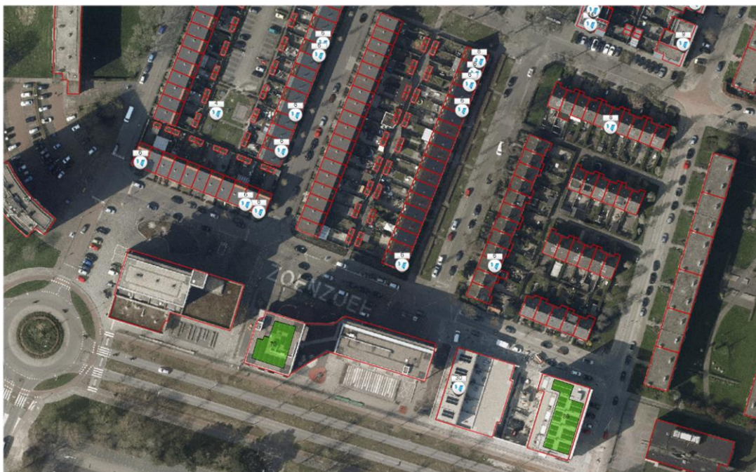
Figuur 3 Detectie zonnepanelen obv luchtfoto
