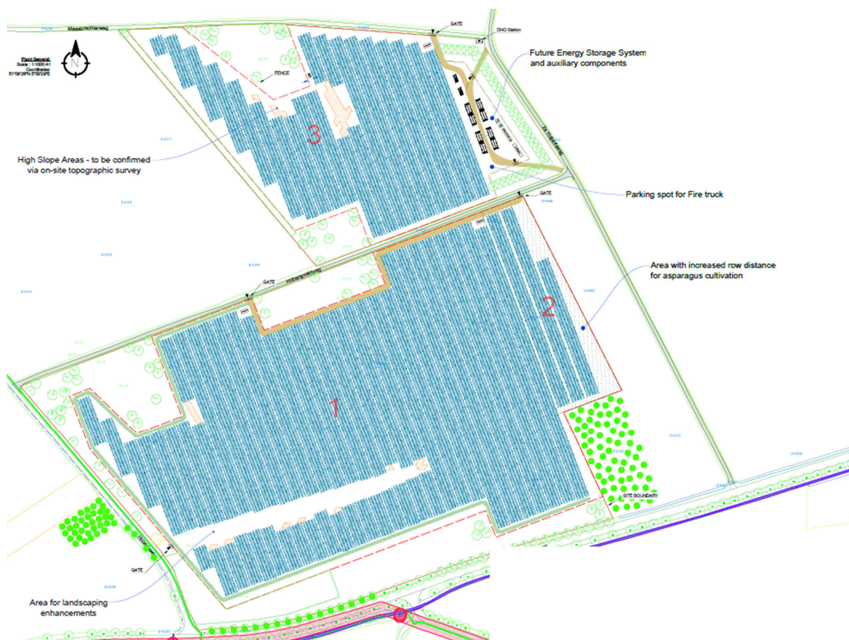
Afbeelding 1. Technisch ontwerp van de zonneweide.
