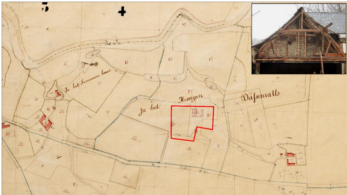
Figuur 13: Uitsnede uit de kadastrale kaart uit 1832. 20 Het plangebied is rood omlijnd. Inzet: oorspronkelijke houten kapspantenconstructie met penverbindingen van de huidige in slooptoestand verkerende vierkantshoeve
