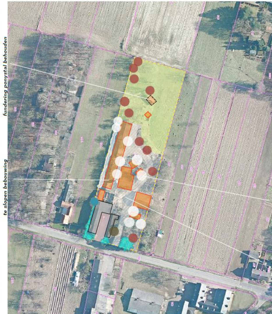
te slopen bebouwing fundering ponystal behouden te rooien in verband met sloopwerkzaamheden
