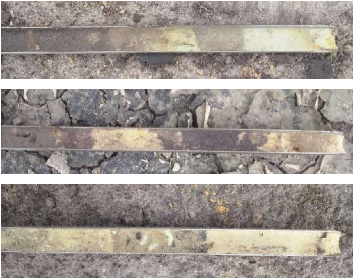
Figuur 19: Foto's van de boringen 1, 3 en 5 met de sterk verstoorde bodemlaag boven de C-horizont.
