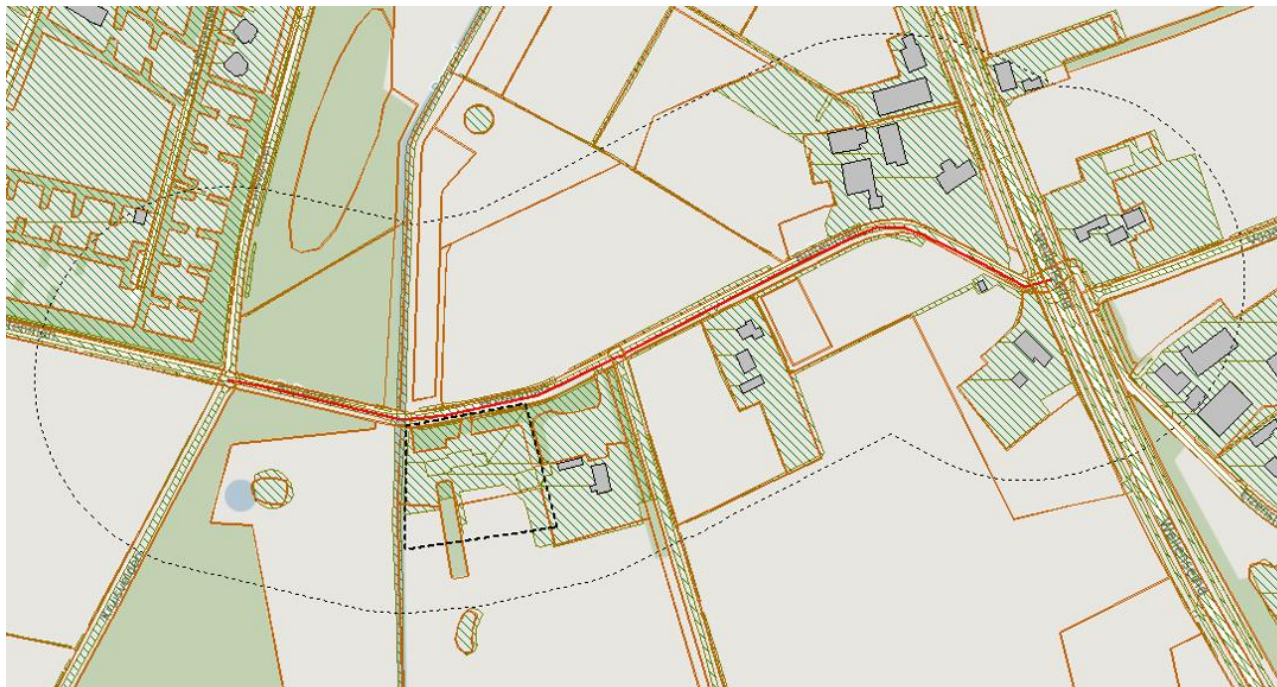
Figuur 8 Overzicht rekenmodel geluidonderzoek Buitenman. De weg wordt aangegeven als rode lijn en de locatie van de te veranderen bestemming is weergegeven met zwarte, dikke gestreepte omlijning. De geluidzone, waarbinnen de geluidcontouren zijn bepaald, is aangegeven met zwarte, dunne gestreepte omlijning.
