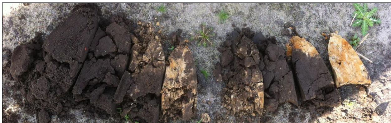
Figuur 5: boring 2 met een geroerde bovengrond.
