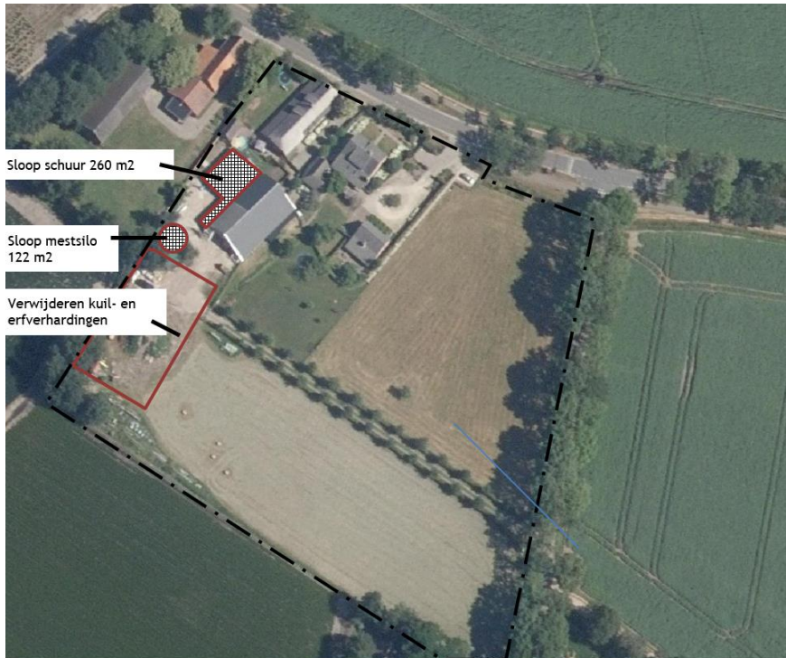
Afbeelding V: overzicht te slopen bebouwing/verharding
