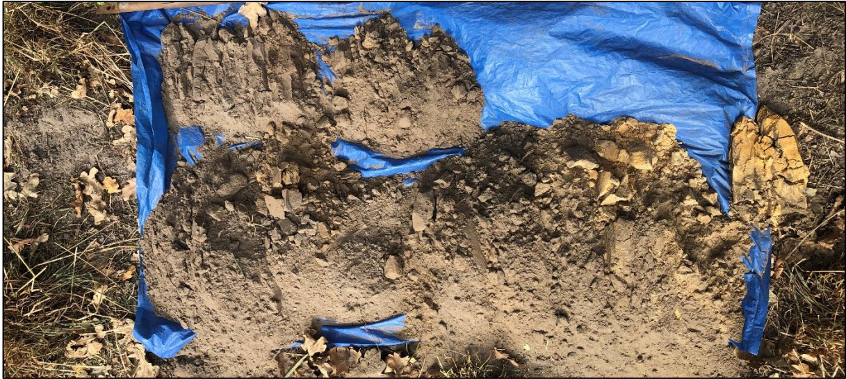
Boring 1: 0-120 cm -Mv. Begonnen met de 7 cm diameter edelmanboor, wegens droogte en uitvallend sediment nogmaals geboord met een 15 cm edelmanboor
